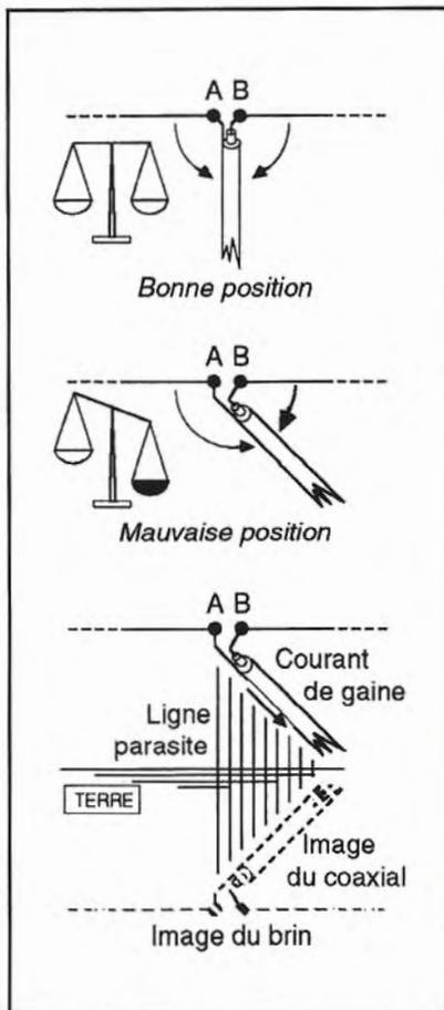
Figure 2 : Mauvaise position d'un coaxial et ses conséquences.
