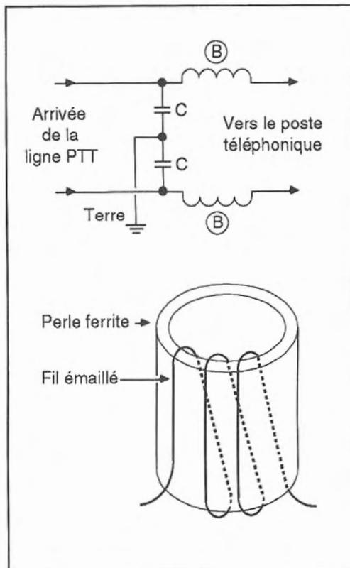
Figure 4 : Circuits passe-bas pour le téléphone
