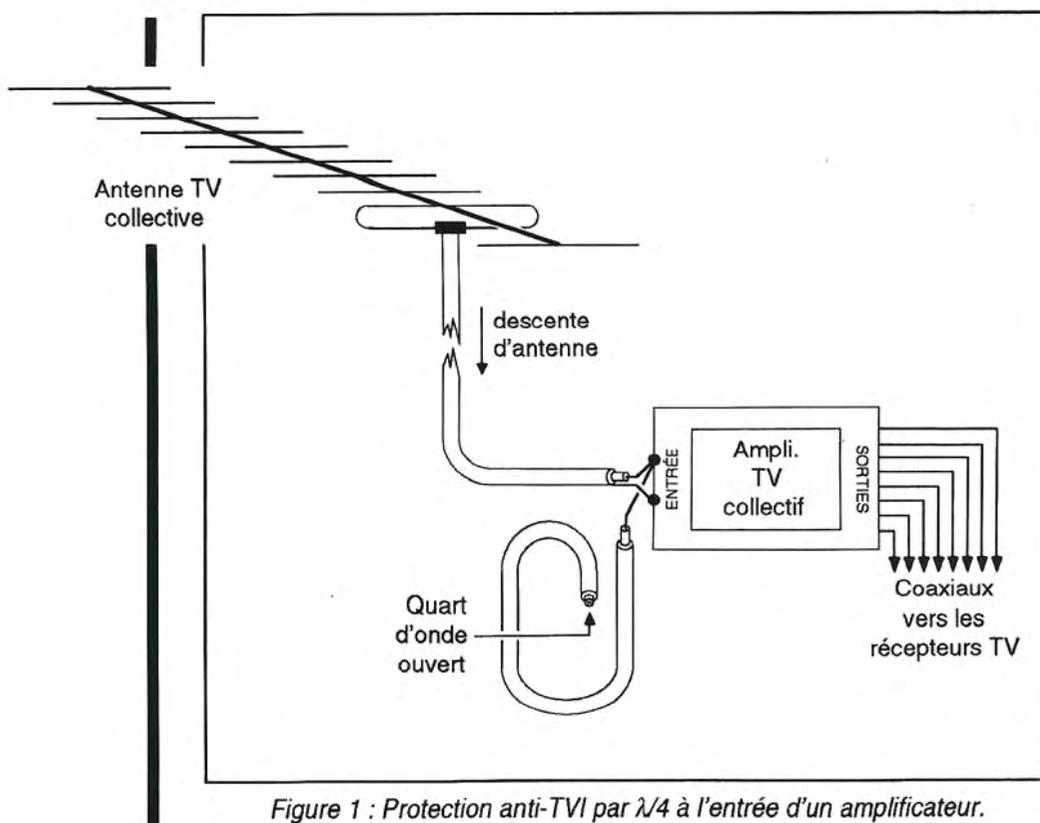
Figure 1 : Protection anti-TV par  $\lambda/4$  à l'entrée d'un amplificateur.
