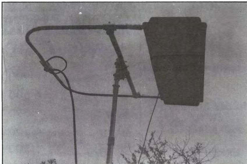
*L'antenne Isoloop en montage horizontal.*
