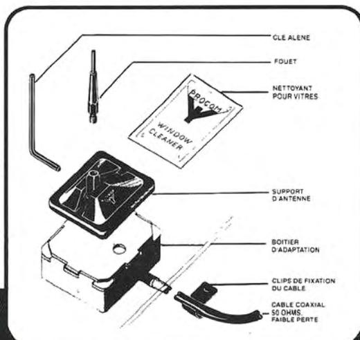
L'antenne se colle instantanément sur le pare-brise ou une vitre !
