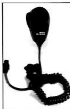
qué par K40 Electronics. Le compresseur de modulation, intégré au micro, rendra votre «module» plus percussive, plus efficace, tout en assurant une limitation de gain. L'originalité de ce micro, c'est qu'il prélève la tension d'alimentation directement sur le circuit de commutation de l'émetteur-récepteur CB. Un condensateur chimique, de forte capacité, assure le maintien de cette tension aux bornes du circuit intégré C-MOS qui
