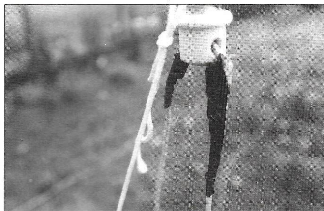
Le haut du triangle : le ruban adhésif empêche le câble de coulisser. La ficelle sert de repère pour la hauteur.
