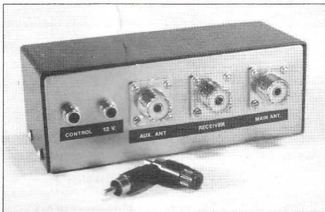
A l'arrière, les prises "antennes".
