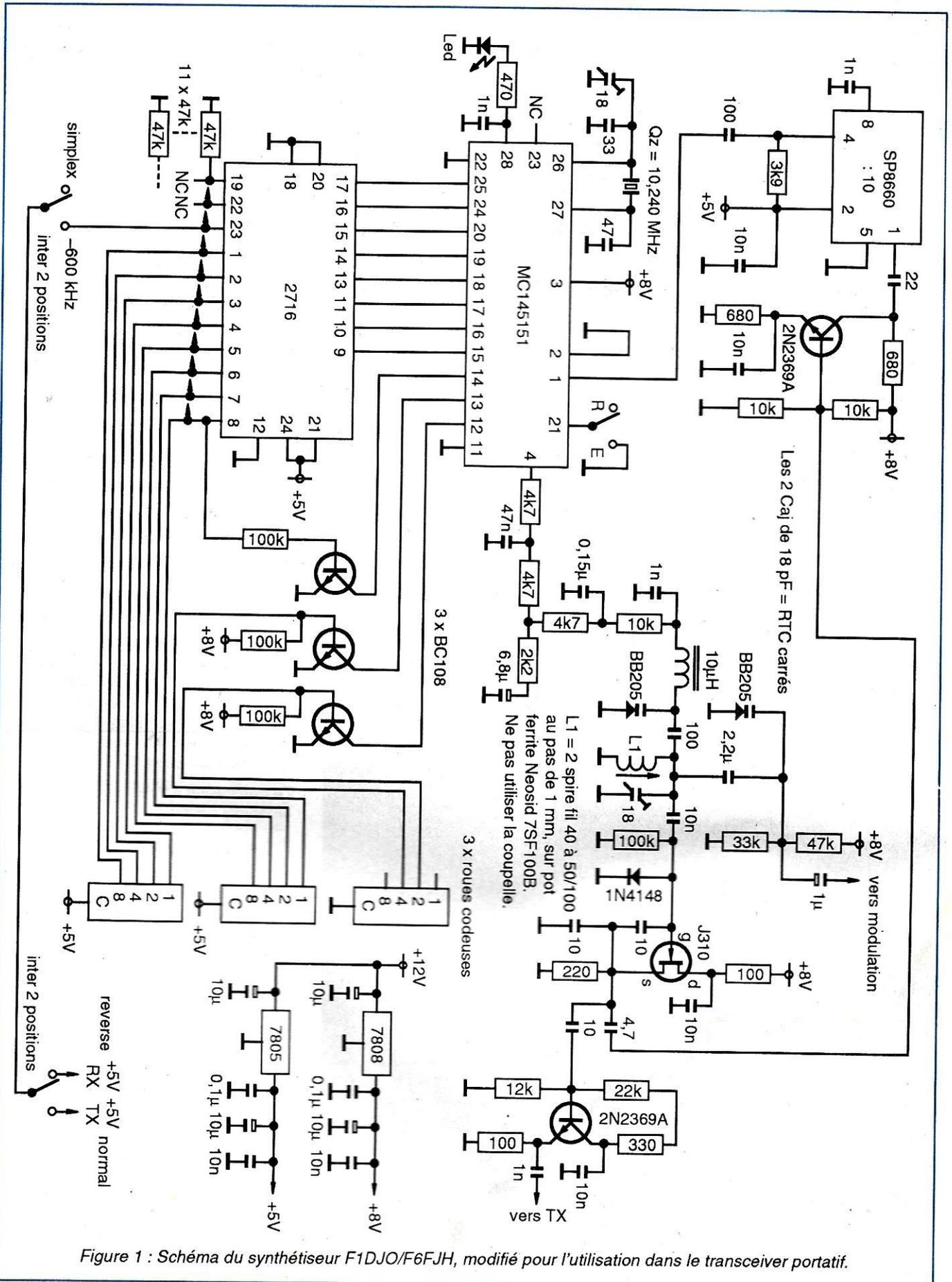
Figure 1 : Schéma du synthétiseur F1DJ0/F6FJH, modifié pour l'utilisation dans le transceiver portable.
