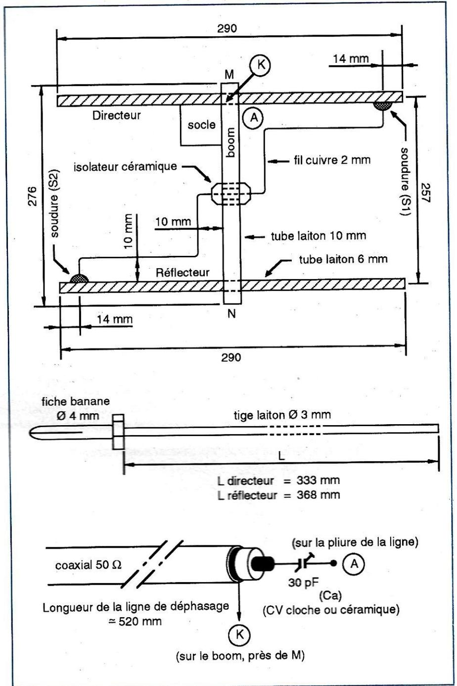
Figure 2 : Schéma de construction du modèle 144 MHz démontable.
