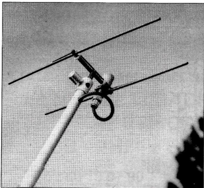
Photo C : HB9CV bande des 70 cm.
