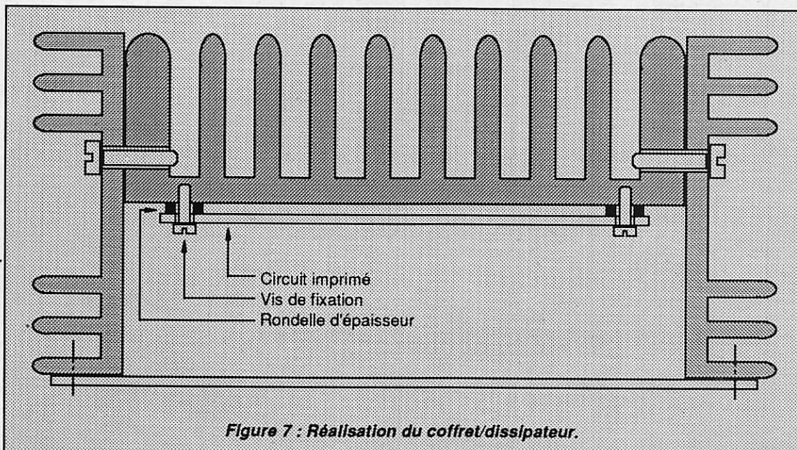
Figure 7 : Réalisation du coffret/dissipateur.
