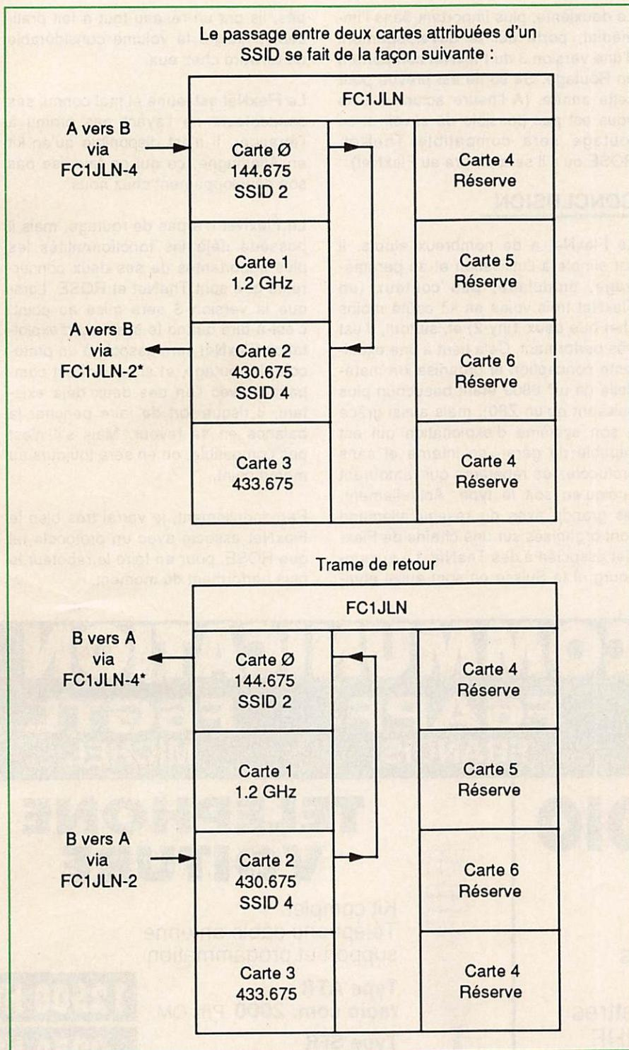
Figure 5 : Schéma du passage entre 2 cartes.
