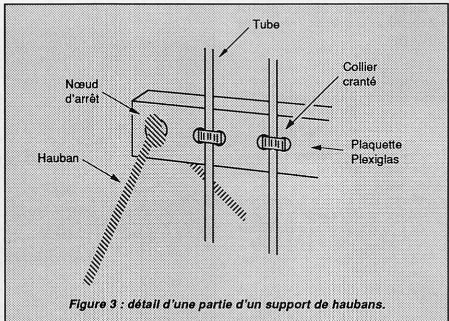
Figure 3 : détail d'une partie d'un support de haubans.
