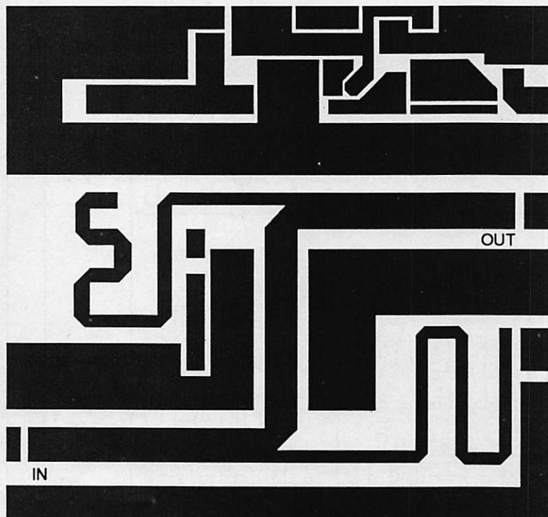
Figure 4 : Circuit imprimé, éch. 1, de l'ampli. 50 W.
