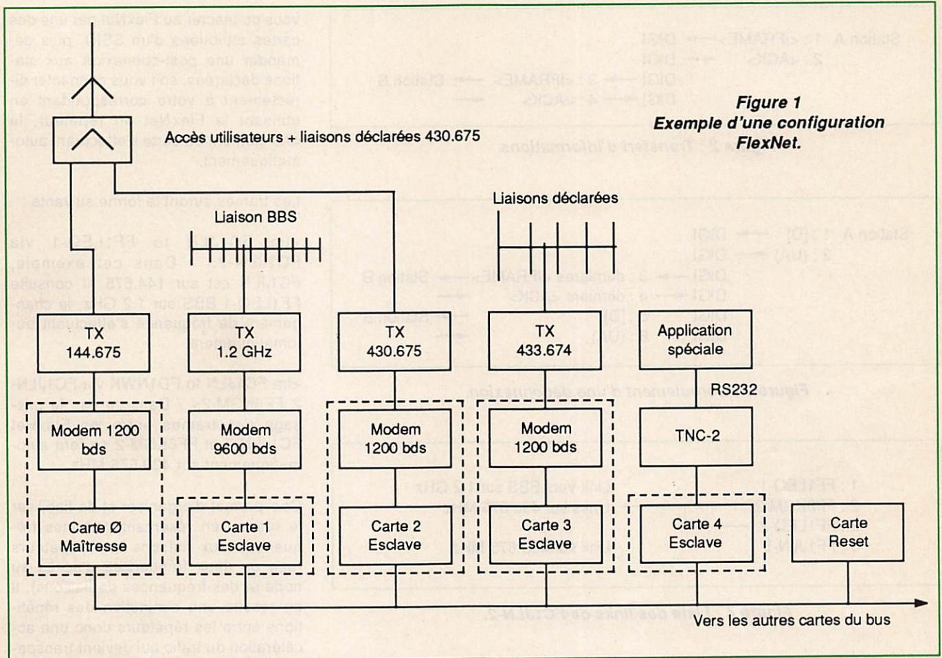
rées. Elle est constituée d'un microprocesseur 6809 travaillant à 4 MHz, entouré d'un VIA 6522 pour l'accès au bus, d'un Z8530 pour la gestion du modem, d'une Eprom 27256 et d'une ou deux RAM 62256.
