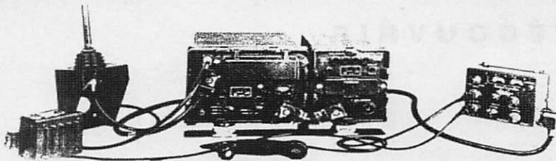
**ENSEMBLE ÉMETTEUR-RÉCEPTEUR TR. VP.1A** couvre de 27 à 39,9 MHz en FM, équipé d'un standard de fréquences contrôlé par impulsions, qui permet de disposer dans tout l'étendue de la bande et avec une très grande stabilité de 130 fréquences échelonnées tous les 100 Hz à positionnement soit automatique ou manuel, sortie HF 16 W. Alim. 24 V continu.
