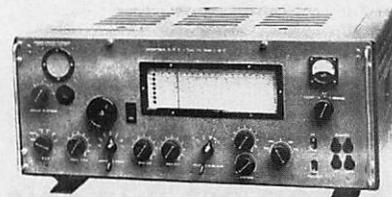
**RÉCEPTEUR DE TRAFIC AME 7G-1680.** Superhétérodyne à double changement de fréquence, couvre de 1,7 à 40 MGz en 7 gammes, sensibilité 1 µV. Alim. secteur 110/220 V, HP incorporé.
