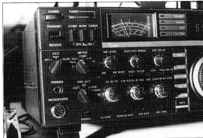
Les commandes à gauche de l'appareil. Notez la commande de la boîte d'accord automatique d'antenne, celle du préamplificateur et celle de l'atténuateur 10, 20 30 dB.
