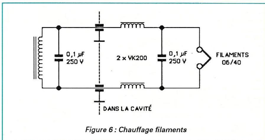
Figure 6 : Chauffage filaments
