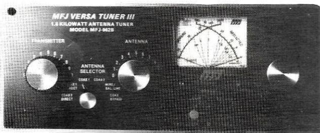
La boîte d'accord antenne MFJ "VERSA TUNER III"
