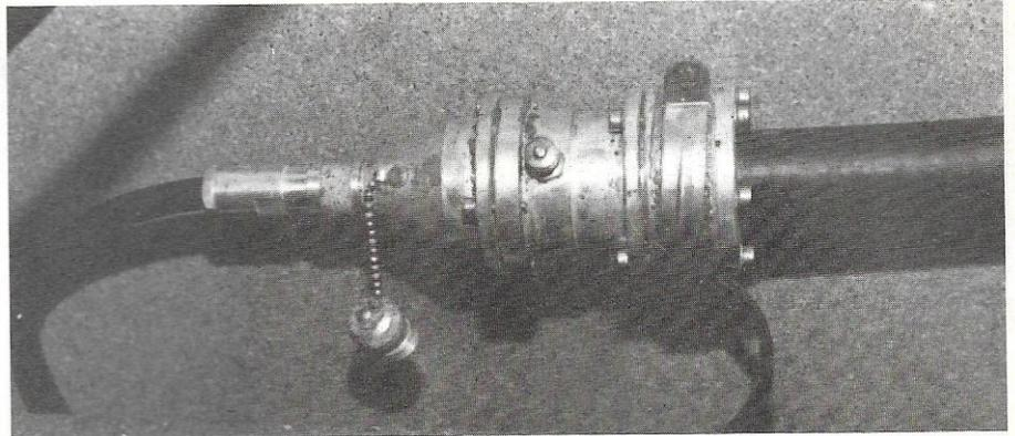
Photo n° 2 : Réducteur/adaptateur câble coaxial Gedelex 9/50 pressurisé
