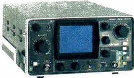
Un oscilloscope simple trace 20 MHz avec trigger à 25 MHz. De taille modeste, cet oscillo égale bien des grands par ses performances. Notez le temps de montée : 17 nS. La trace est d'une définition exemplaire.
