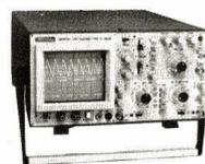
2 x 20 MHz. Sensibilité verticale 5 mV/div. Ligne à retard. Testeur de composants. Recherche automatique de la trace. Deux sondes (x 1, x 10) ..... **4699 F**
