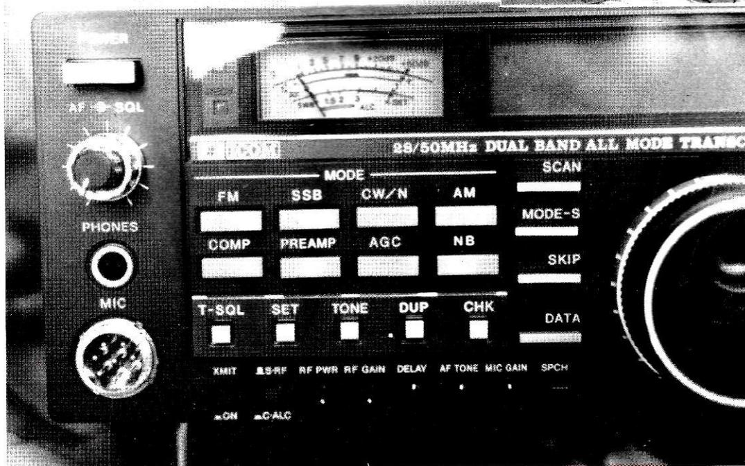
Détail de la face avant de l'IC-575A
