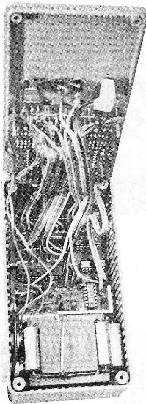
monter séparément les circuits d'affichage ( $IC_1$  à  $IC_5$  et  $AFF_1$  à  $AFF_4$ ), et à les relier au reste du montage par un bus de méplat à 16 conducteurs ( $4 \times 4$  bits) et 2 fils d'alimentation de plus forte section (voir **photo 2**).
