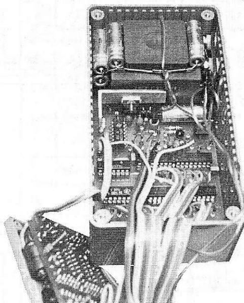
*Photo 4 : Deux des condensateurs de filtrage trouvent une place dans un espace situé sur le côté du transformateur. Dans la mesure de vos moyens, il faudra fabriquer un radiateur efficace pour IC<sup>9</sup> que l'on enduira généreusement de graisse aux silicônes ou à l'oxyde de béryllium avant l'assemblage.*
