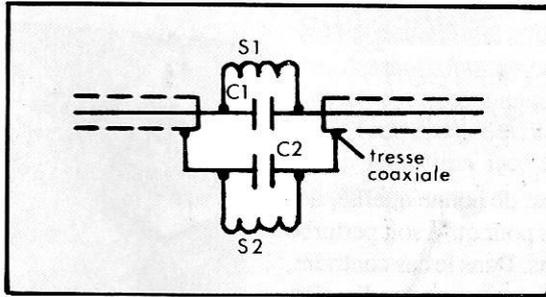
Dans ce filtre C1 - C2 — 15 pf ; L1 L2 selfs de 2,2 micro H. Ce filtre est très efficace mais on peut lui reprocher d'être accordé. Il nécessite donc l'utilisation d'appareils de mesure pour construire les selfs.
