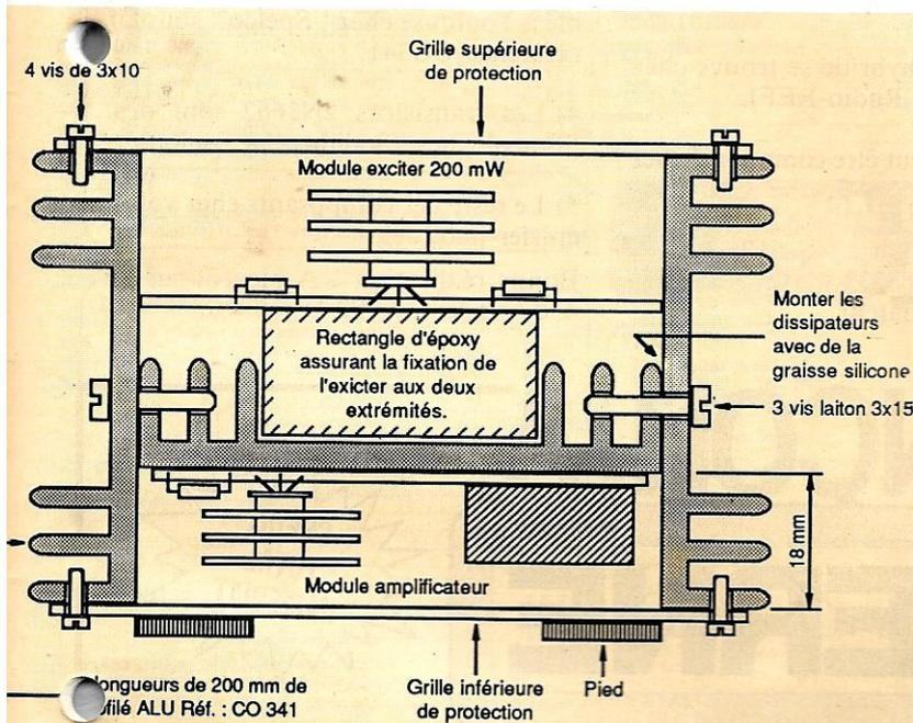
Figure 4 : coupe transversale de l'émetteur
