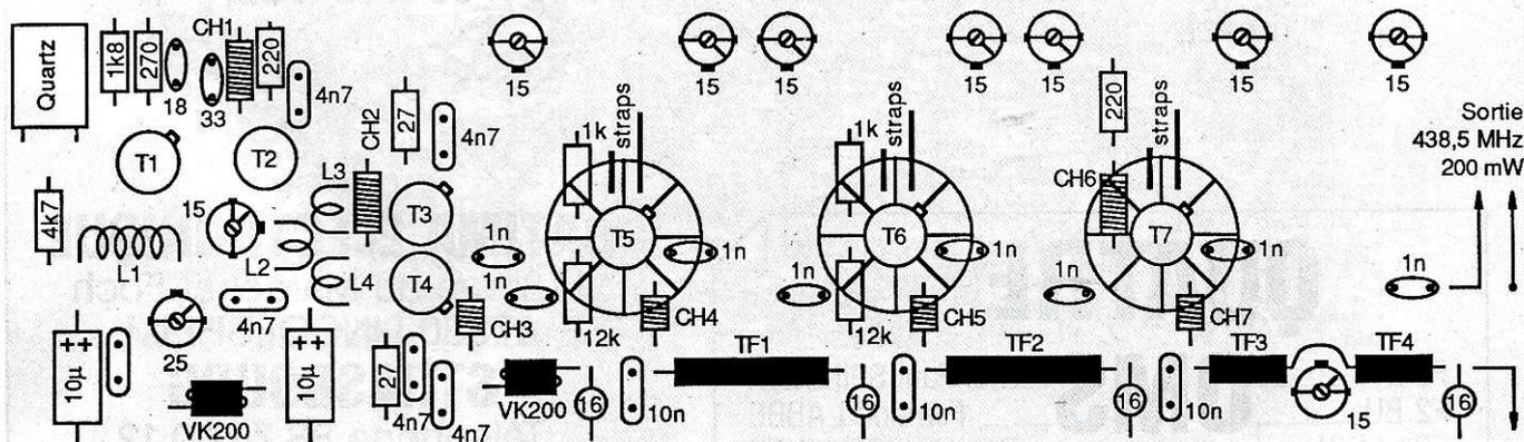
La patte de tous les composants allant à la masse sera soudée des deux côtés du circuit imprimé (straps compris)
