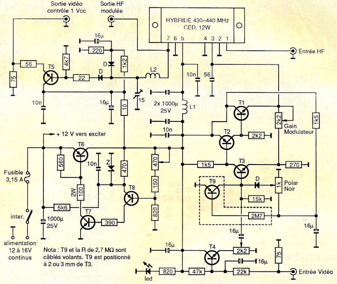
Nota : T9 et la R de 2,7 MΩ sont câblés volants. T9 est positionné à 2 ou 3 mm de T3.
