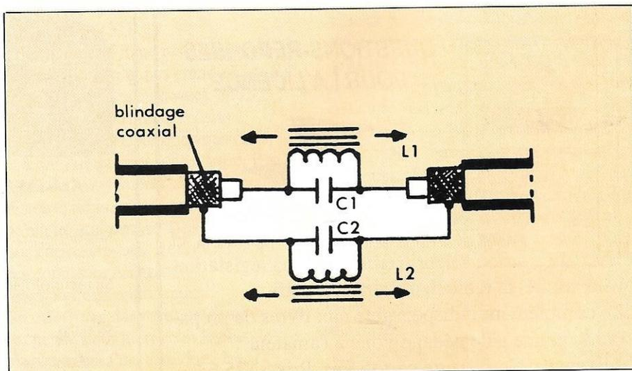
C1 C2 condensateurs au mica, L1 L2 en fil de cuivre émaillé 3/10ème enroulé en 4 spires jointives sur mandrin de diamètre 8 mm avec noyau.
