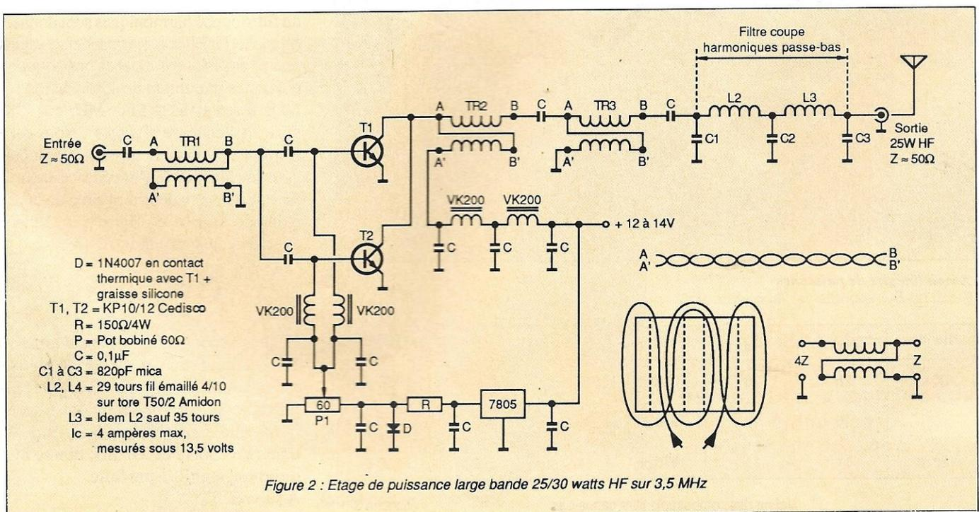
Figure 2 : Etage de puissance large bande 25/30 watts HF sur 3,5 MHz
