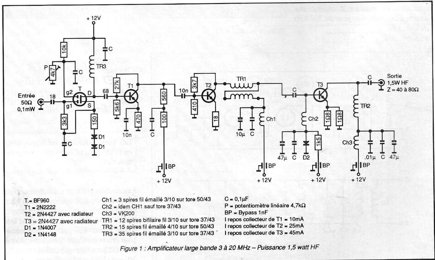
Figure 1 : Amplificateur large bande 3 à 20 MHz – Puissance 1,5 watt HF
