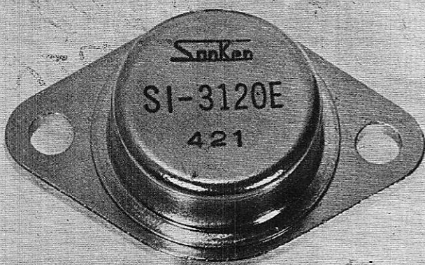
Le régulateur + 12 V intégré.
