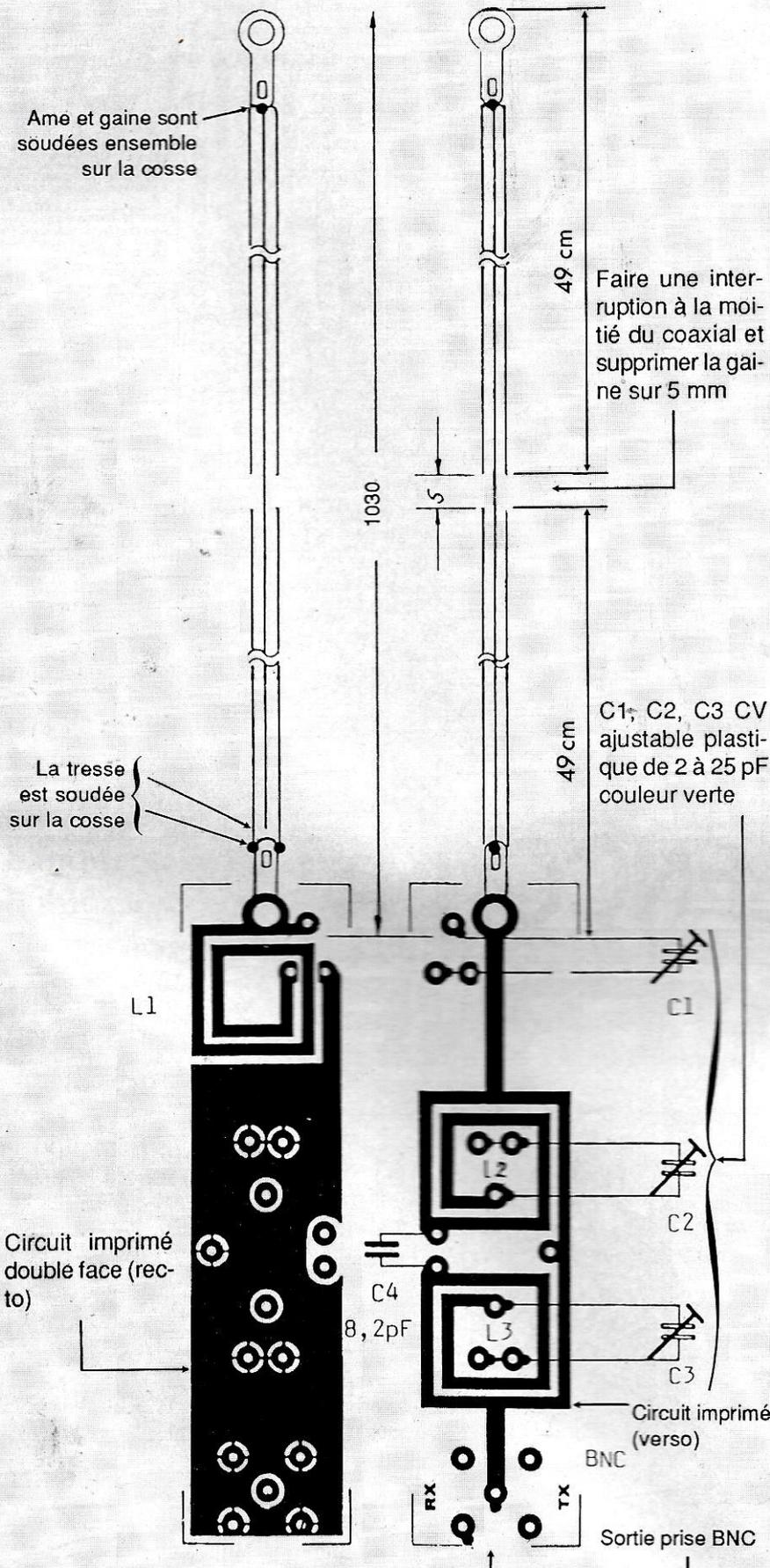
Figure 3 : Schéma pratique de l'antenne portable 144 MHz (échelle 1/1)
