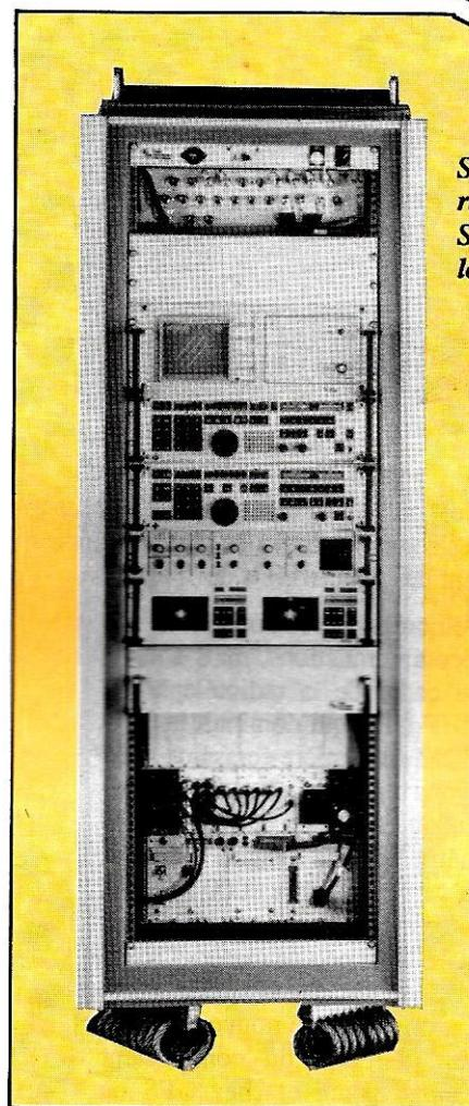
Système de radiogoniométrie Saigon basé sur le Télégón 10 de Telefunken.
