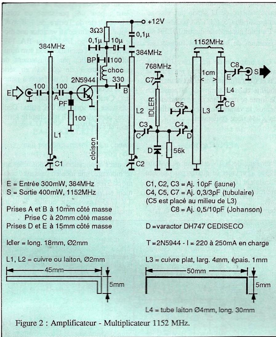
Figure 2 : Amplificateur - Multiplicateur 1152 MHz.
