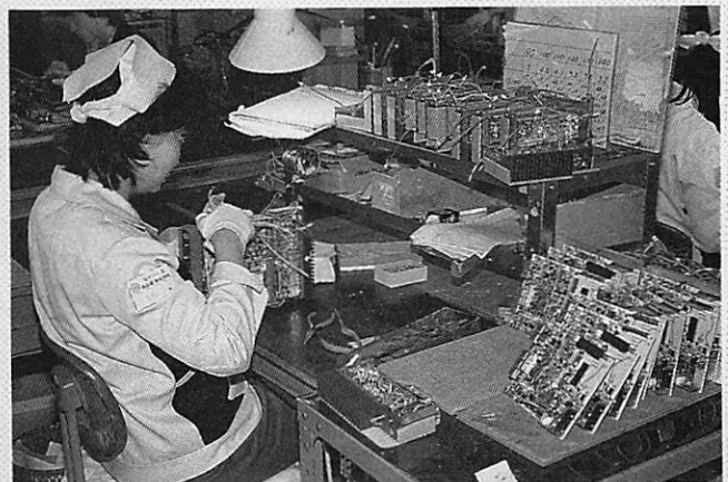
Insertion des sous-ensembles dans les boîtiers.
