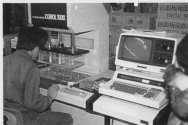
Test automatique des sous-ensembles.
