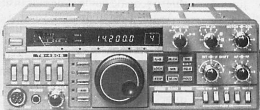
Émetteur-récepteur TS 430 SP* USB-LSB-AM-FM en option - CW/Émetteur bandes amateurs - 100 W HF CW - 200 PEP - Final à transistors / Rx à couverture générale / Alimentation 12 V - 20A - Externe.
