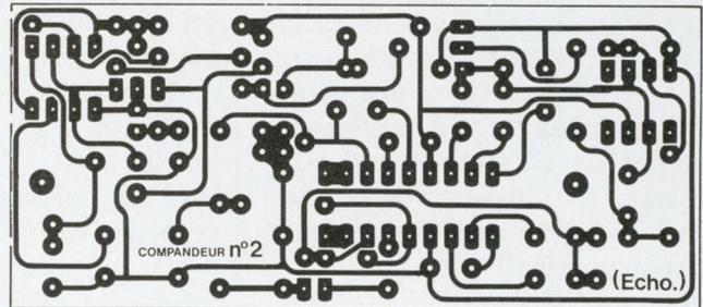
Fig. 11 : Compandeur écho : côté pistes.
