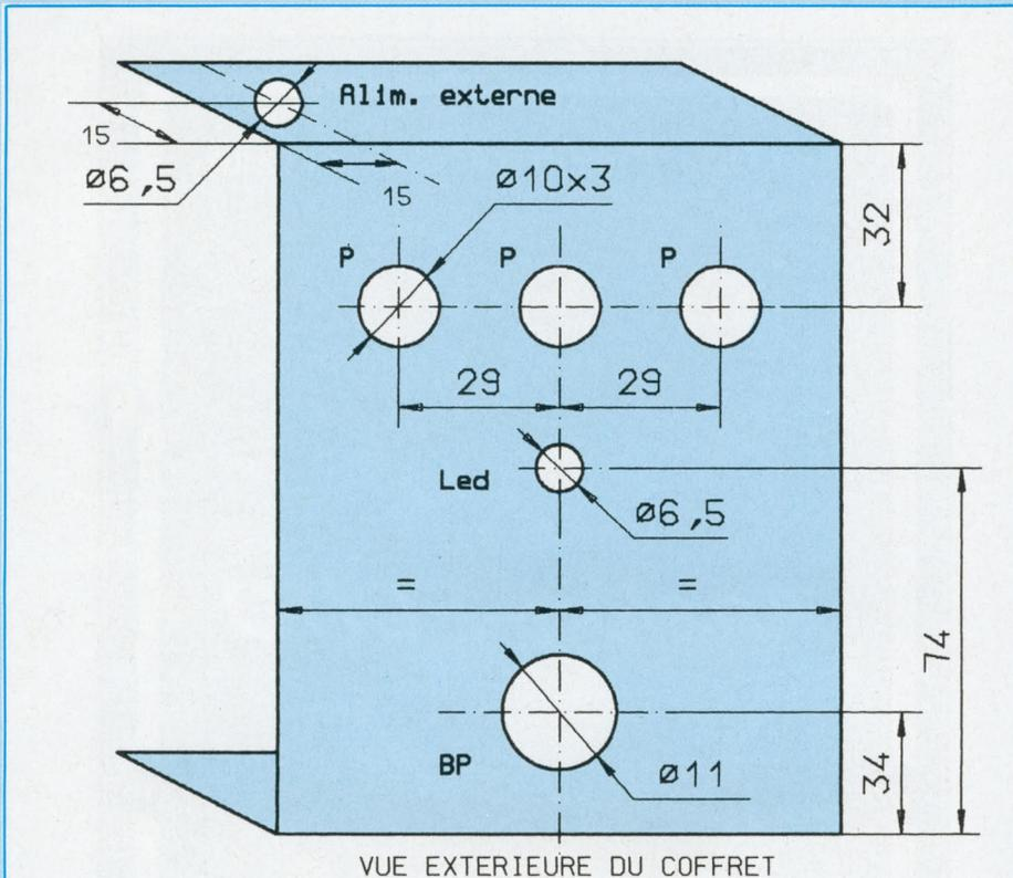
Fig. 13b : Perçage de la face avant.
