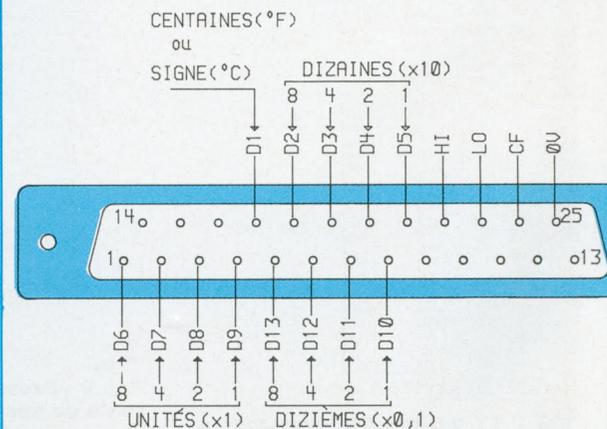
Fig. 14 : Connecteur de sorties vu côté soudures.
