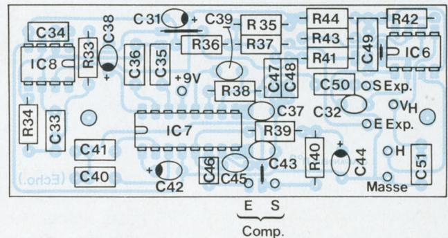
Fig. 12 : Compandeur écho : côté composants.
