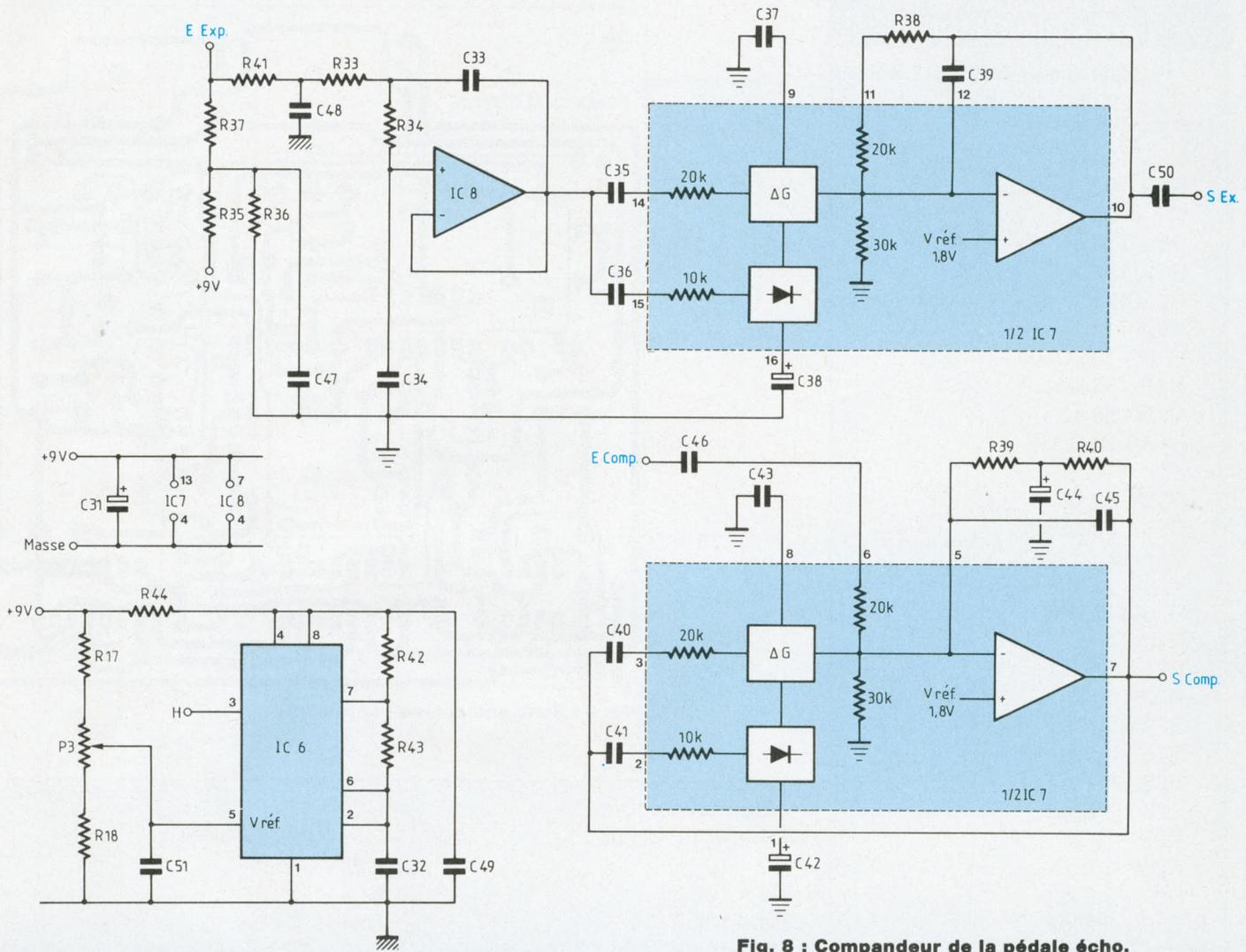
Fig. 8 : Compedeur de la pédale écho.
