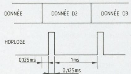
Fig. 4 : Précis temporel des sorties du module FE33L.
