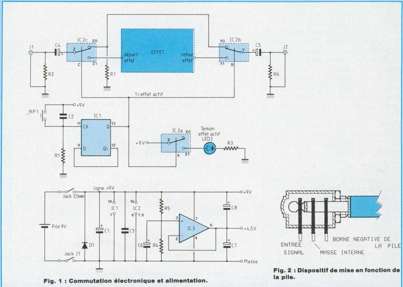
Fig. 1 : Commutation électronique et alimentation.
