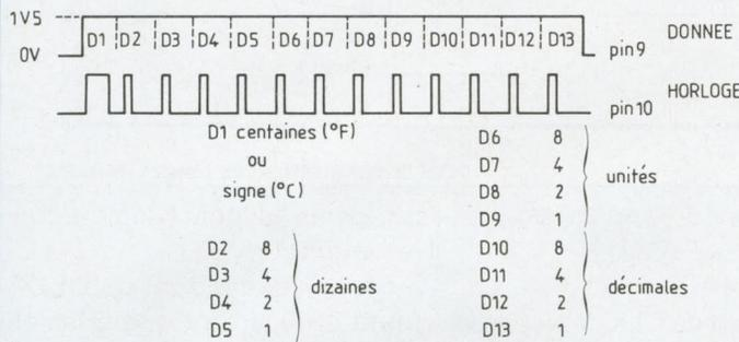
Fig. 2 : Format des sorties Donnée et Horloge.
