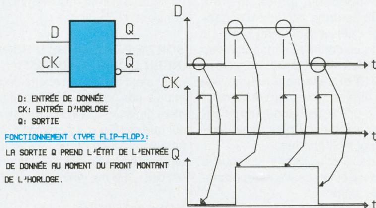
Fig. 6 : Rappel du fonctionnement des bascules D.
