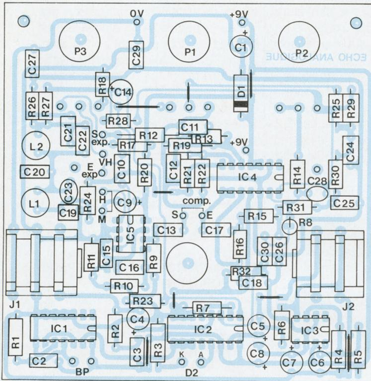
Fig. 10 : Echo analogique : côté composants.
