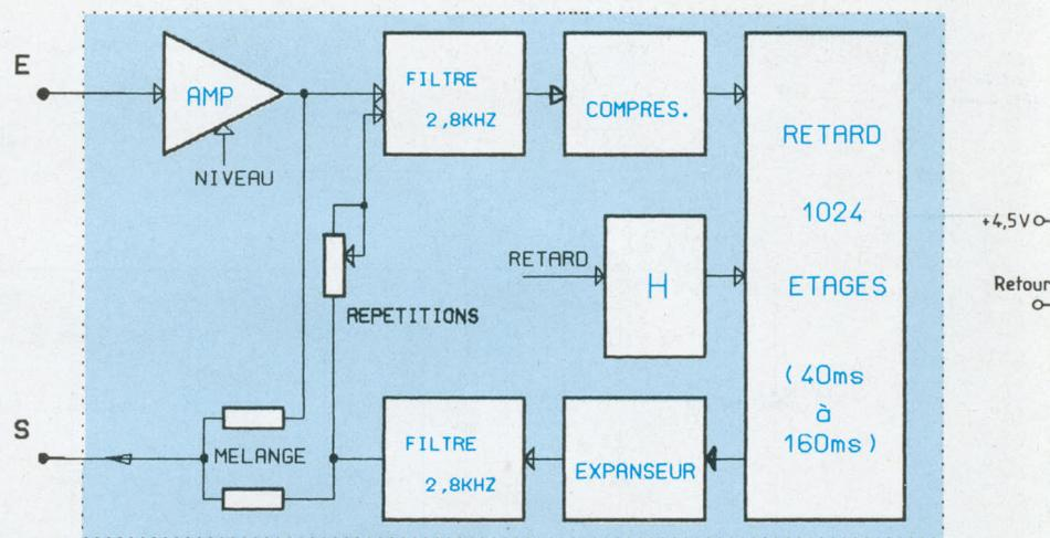
Fig. 4 : Schéma fonctionnel de l'écho analogique.
