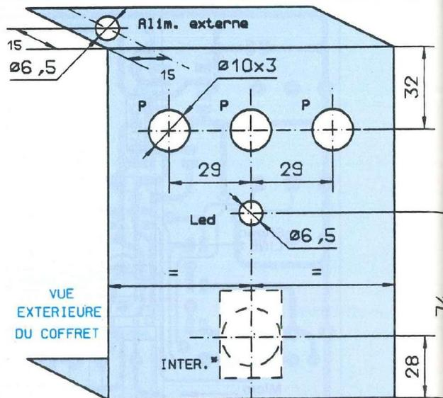
Fig. 6b : Perçage de la face avant.
