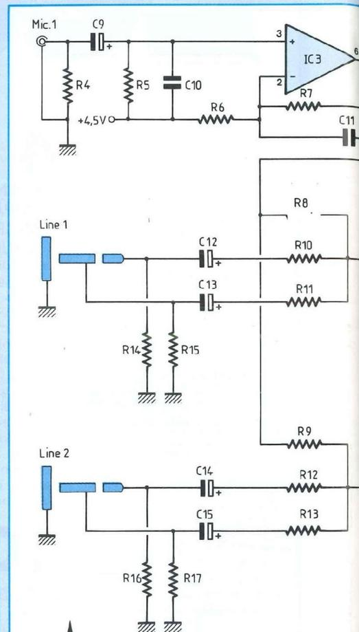
Fig. 2 : Schéma structurel du préampli mélangeur.
