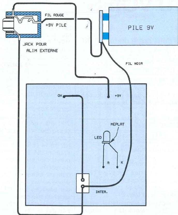
Fig. 7 : Plan de câblage du module.
