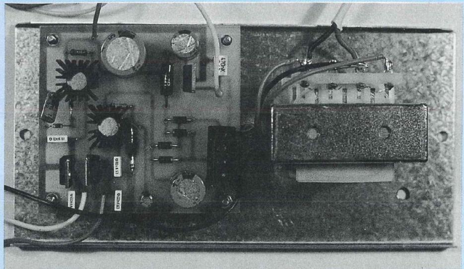
On commencera par mettre en place, sur la face arrière, le transformateur et la platine d'alimentation, équipée de ses fils de sortie. Pour ces derniers, ne pas hésiter à choisir des sections assez importantes, bien que les intensités véhiculées par les sorties +9 V et -8 V
