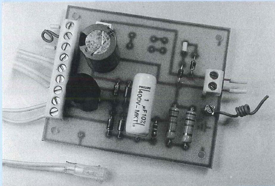
**Nous allons étudier et construire une alimentation secteur stabilisée, de tension fixe de valeur (au choix) comprise entre 0,7 et 30 V, capable de délivrer un courant d'intensité 100 mA. Le montage ne comportera ni transformateur ni C.I. régulateur de tension.**
