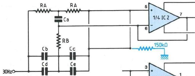
Afin d'éviter tout risque d'instabilité de fonctionnement due à l'énorme impédance d'entrée des amplis opérationnels LF 353 et TL 074, il est préférable de relier leurs entrées (+) à la masse au travers de résistances de 150 kΩ.
