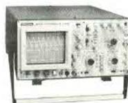
2 x 20 MHz. Sensibilité verticale 5 mV/div. Ligne à retard. Testeur de composants. Recherche automatique de la trace. Deux sondes (x 1, x 10) ..... **4699 F**
