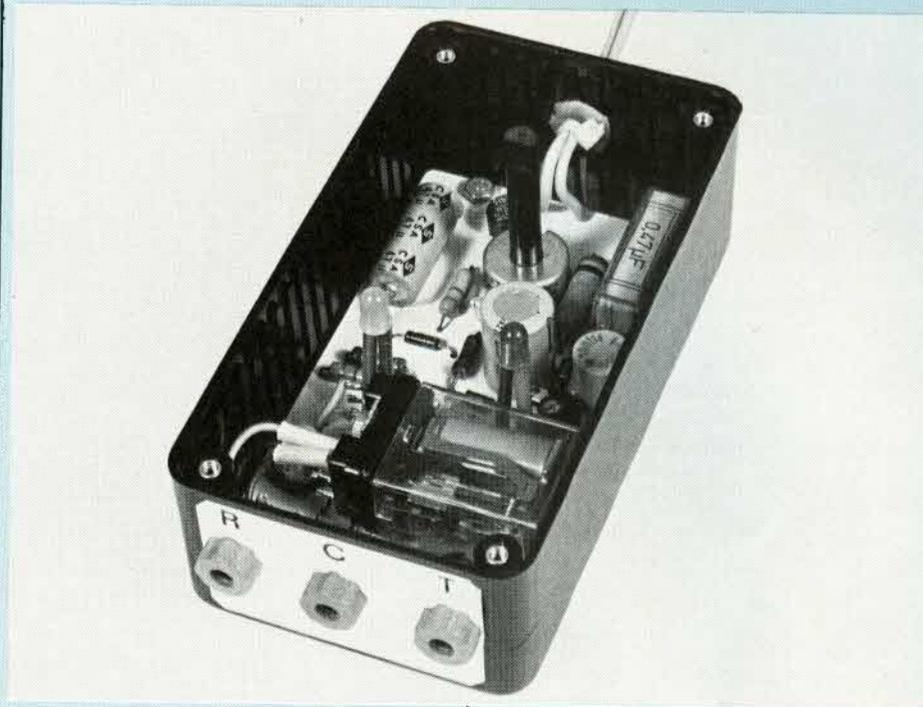
quel autre type de relais puisque ne sortent sur le circuit imprimé que les liaisons bobine, les contacts R, C, T étant à brancher directement sur les douilles bananes sur l'un des côtés du boîtier.
