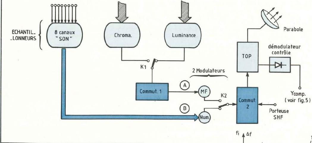
Fig. 4 : Synoptique du codeur C-MAC-paquets.
