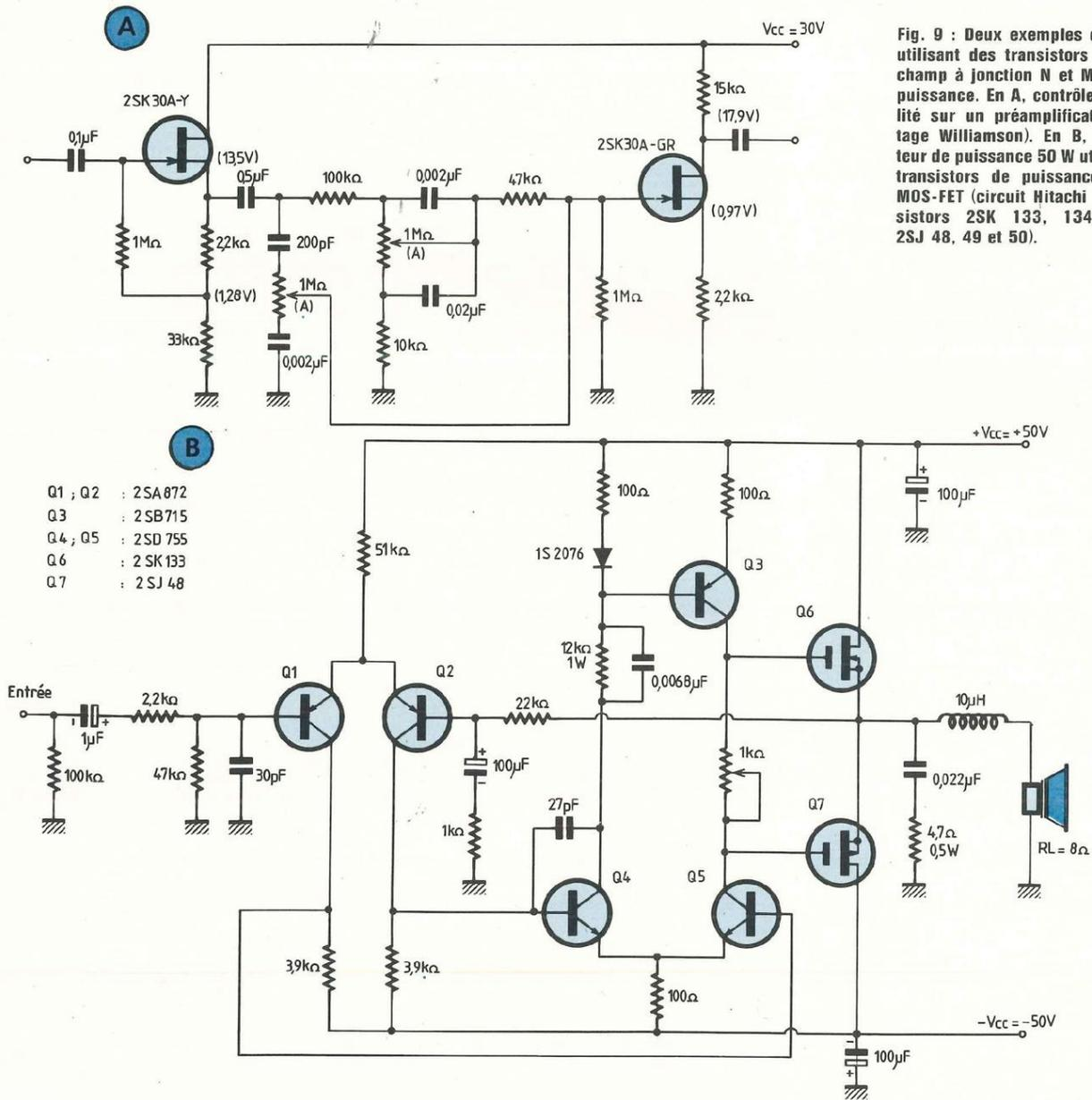
Fig. 9 : Deux exemples de circuits utilisant des transistors à effet de champ à jonction N et MOS-FET de puissance. En A, contrôles de tonalité sur un préamplificateur (montage Williamson). En B, amplificateur de puissance 50 W utilisant des transistors de puissance de type MOS-FET (circuit Hitachi pour transistors 2SK 133, 134, 135 et 2SJ 48, 49 et 50).
