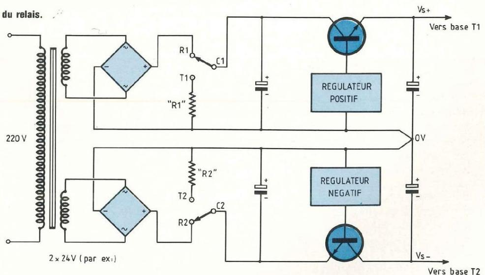
Fig. 2 : Connexions relais. Alimentation à protéger (version incorporée).
