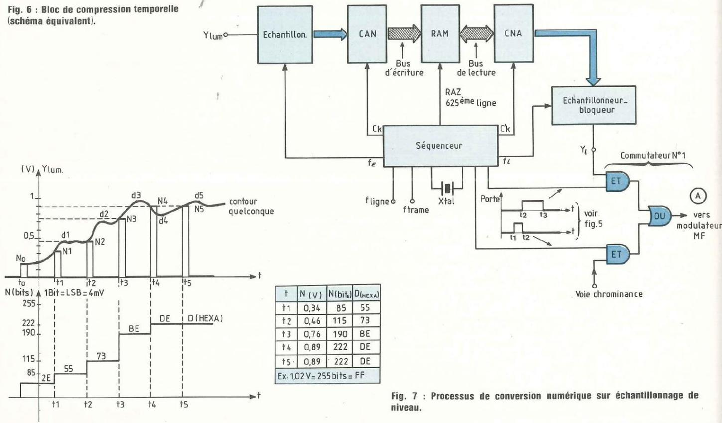
Fig. 7 : Processus de conversion numérique sur échantillonnage de niveau.
