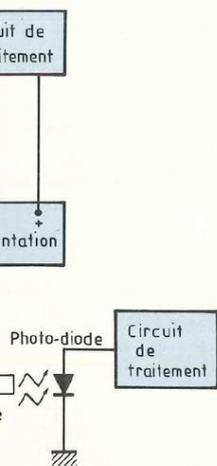
Pour les transmissions à flux, particulièrement intenses, le montage de la figure 4 peut être très facilement adapté à une liaison par fibre optique, comme le montre la figure 5, une LED d'émission et une photodiode de réception servant d'interface. On bénéficie aussi naturellement en plus de tous les avantages bien connus des liaisons par fibre optique, c'est-à-
