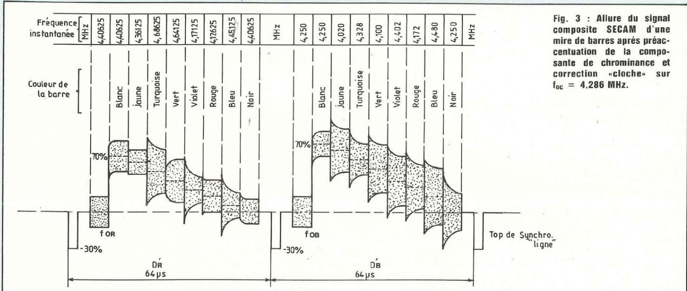
Fig. 3 : Allure du signal composite SECAM d'une mire de barres après préaccentuation de la composante de chrominance et correction « cloche » sur  $f_{oc} = 4,286$  MHz.
