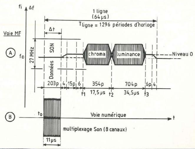
Fig. 5 : Composition du signal multiplexé C2-MAC-paquet.
