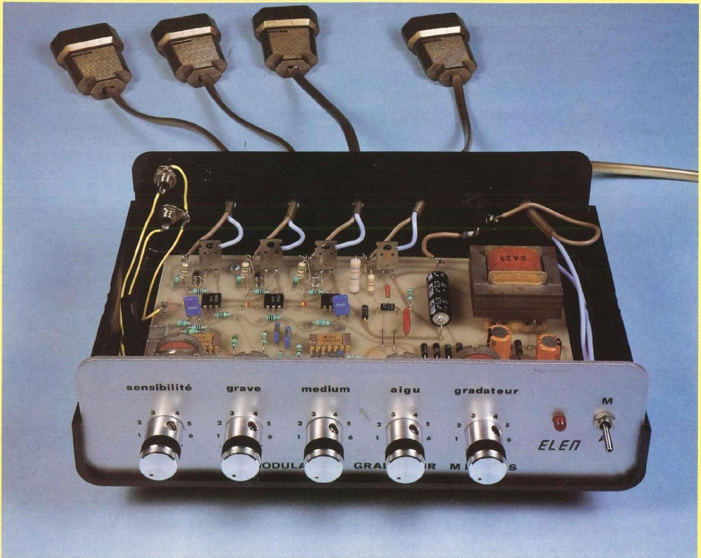
Un deuxième boîtier LM 324 fournit trois des quatre ampli-op qu'il contient pour l'élaboration des trois filtres actifs. Le premier de ces filtres, du type passe-bas à source contrôlée apporte une atténuation de 12 dB par octave à partir de sa fréquence de coupure qui a pour valeur :
