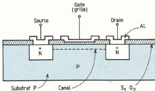
Fig. 4 : Structure d'un transistor MOS-FET de puissance, canal N. Caractéristique  $I_D/V_{DS}$  en fonction des variations de polarisation (positive) de  $V_{GS}$ . A noter que ce type de transistor travaille par effet d'enrichissement, la tension de polarisation  $V_{GS}$  étant positive et non négative.
