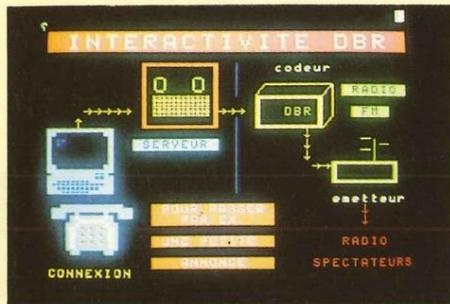
Fig. 6 : Principe d'une liaison Radiovision interactive.
