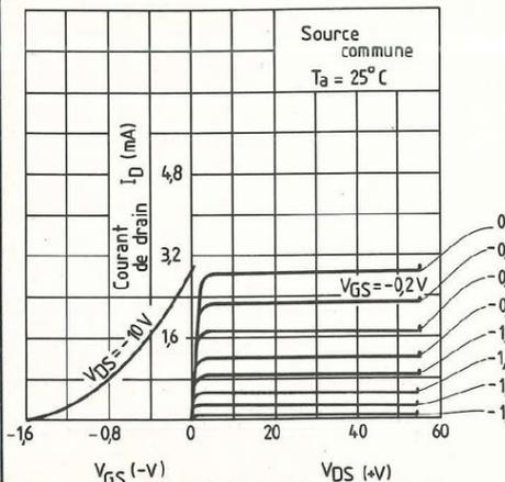
Fig. 3 : Caractéristique  $I_D/V_{DS}$  en fonction des variations de polarisation  $V_{GS}$  du transistor à effet de champ jonction canal N, 2SK 30 AGR. Les courbes ne sont pas sans rappeler celles d'un tube pentode.
