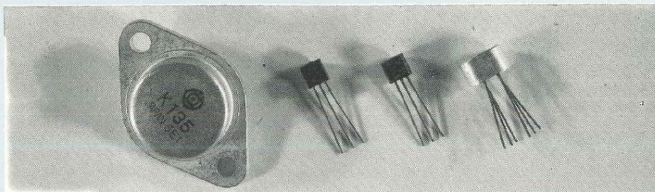
De gauche à droite : transistor MOS-FET de puissance 2SK 135, transistors FET à jonction canal N et P 2SK 30 AGR, 2N 5465, double transistor (paire) FET à jonction, canal N, de référence 2SK 240.
