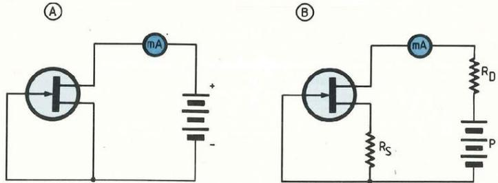
Fig. 6 : Mesure de la valeur du  $I_{DSS}$  d'un transistor à effet de champ, jonction canal N. En A, mesure conventionnelle. En B, mesure tenant compte des conditions réelles d'utilisation (polarisation de gate, charge de drain, tension d'alimentation).
