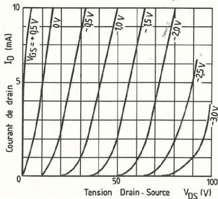
Fig. 5 : Caractéristiques  $I_D/V_{DS}$ , en fonction des variations de polarisation de gate  $V_{GS}$  d'un transistor à effet de champ vertical (V-FET) de référence 2SK 63. Elles rappellent celles d'un tube triode.
