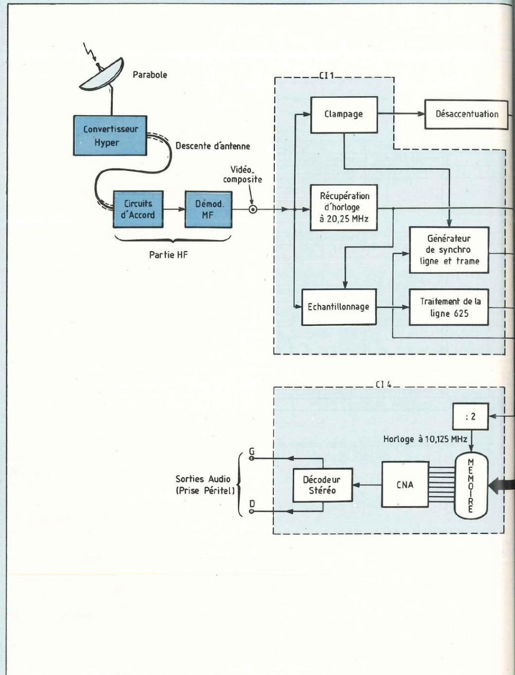
Fig. 12 : Organigramme de décodeur D2-MAC. (CI : Circuit d'implantation d'un ou plusieurs circuits intégrés).
