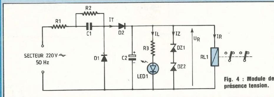
Fig. 4 : Module de présence tension.
