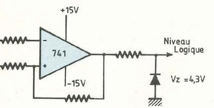
Fig. 14 : Limitation de la tension de sortie par une résistance en série et un zéner à la masse.
