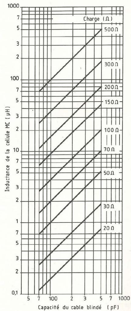
Fig. 5 : Abaque permettant de connaître la valeur optimale de la charge en fonction de la cellule et du câble blindé utilisé.
