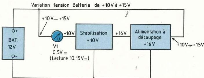
Fig. 10 : Le circuit de mesure, schéma synoptique.
