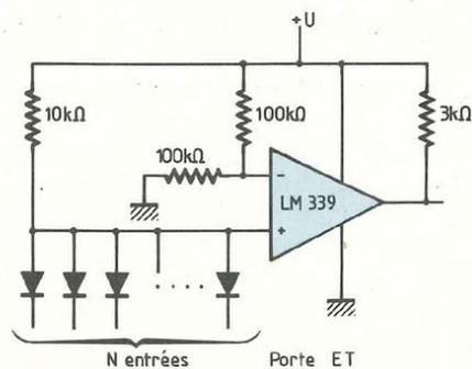
Fig. 17 : Porte ET réalisée à partir d'un comparateur.
