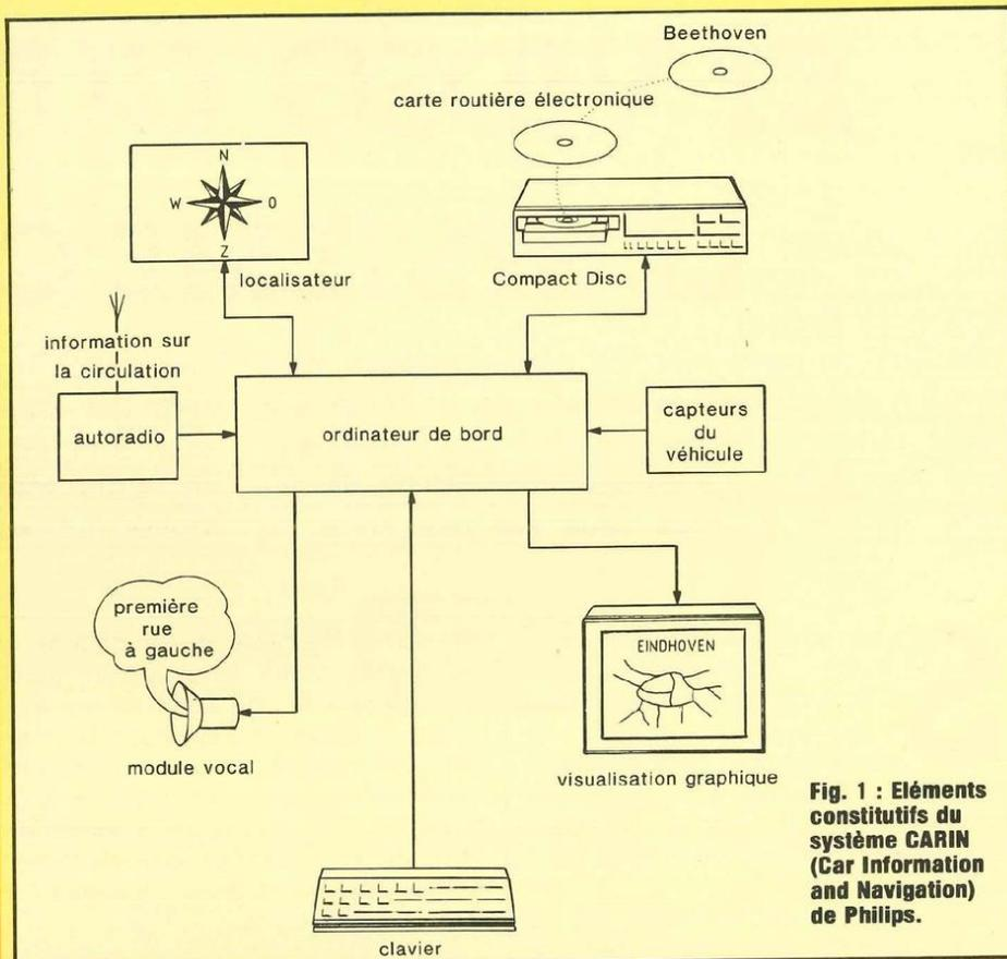
Fig. 1 : Eléments constitutifs du système CARIN (Car Information and Navigation) de Philips.
