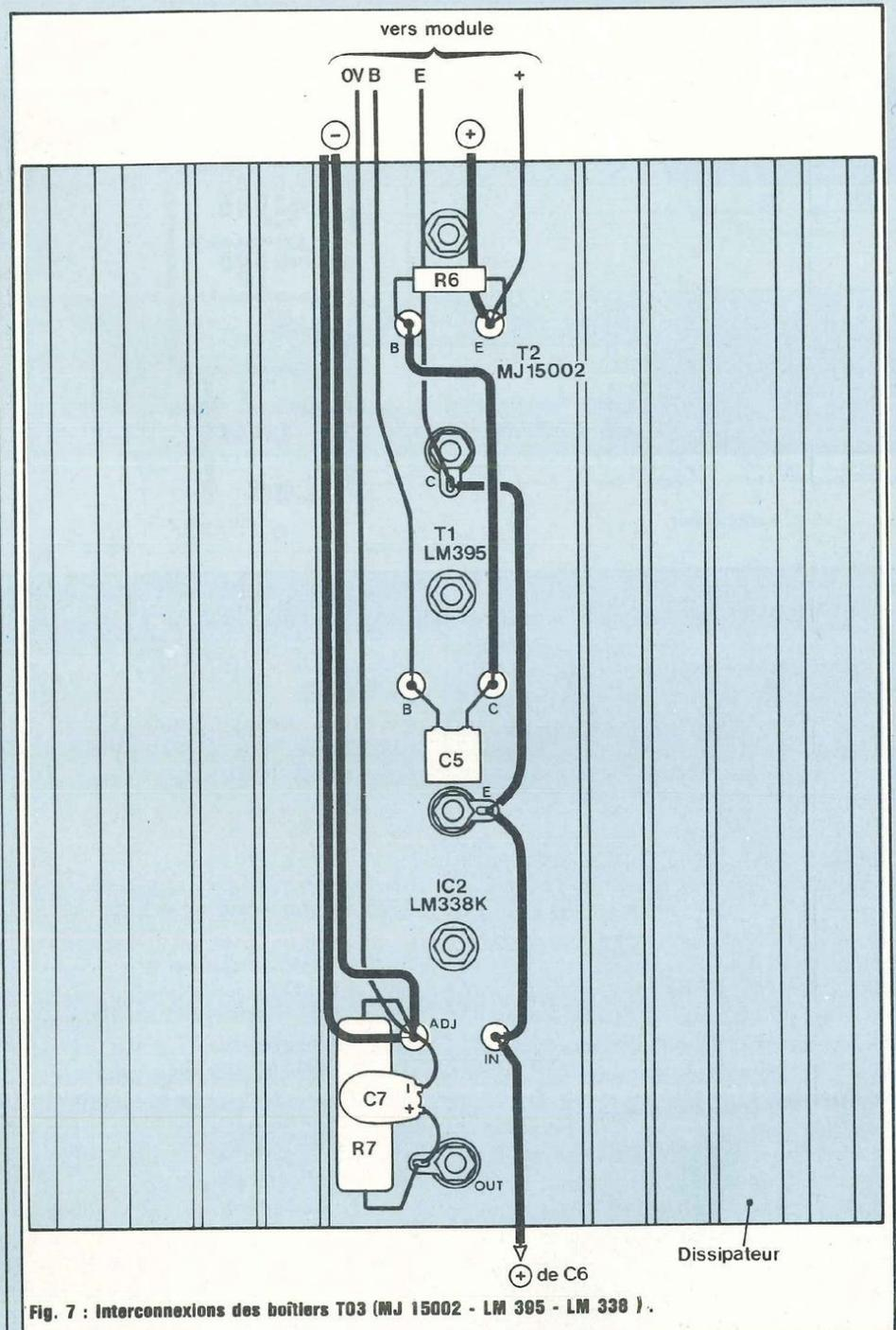
Fig. 7 : Interconnexions des boîtiers TO3 (MJ 15002 - LM 395 - LM 338 ).
