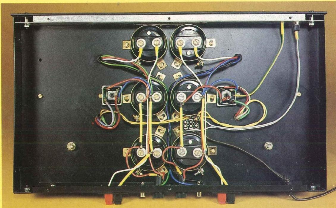
Vue du câblage à effectuer sous le châssis au niveau des ponts redresseurs, condensateurs, transformateurs...
