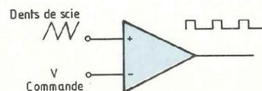
Fig. 19 : Dent de scie appliquée sur l'entrée (+).
