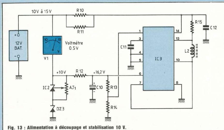
Fig. 13 : Alimentation à découpage et stabilisation 10 V.
