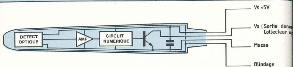
Fig. 2 : Le détecteur optique est constitué d'une diode électroluminescente et d'une photodiode qui capte lumière réfléchie. Lecteur de codes barres à sortie numérique HEDS-3050 Hewlett-Packard — les barres absorbent la lumière — les espaces réfléchissent la lumière
