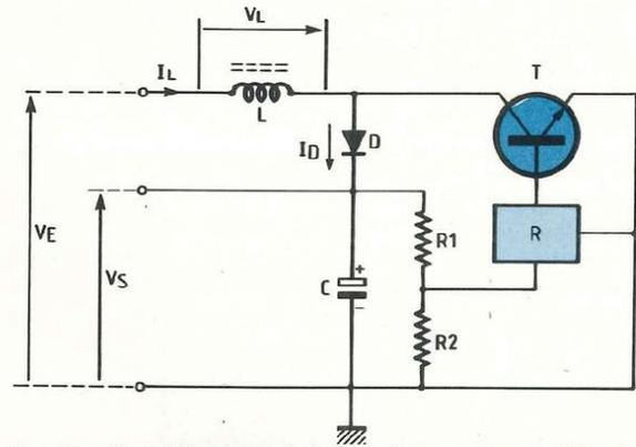
Fig. 11 : Synoptique de principe de l'alimentation à découpage.
