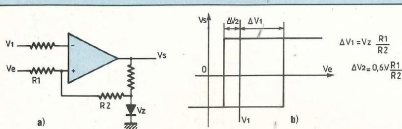
Fig. 8 : Bascule de Schmitt à valeurs de transition non symétrique par rapport à  $V_1$ .
