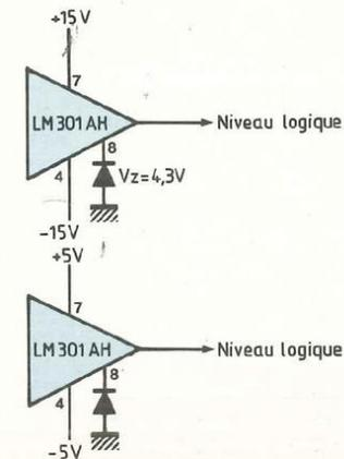
Fig. 15 : Réglage du niveau de sortie par l'entrée de compensation du LM301.
