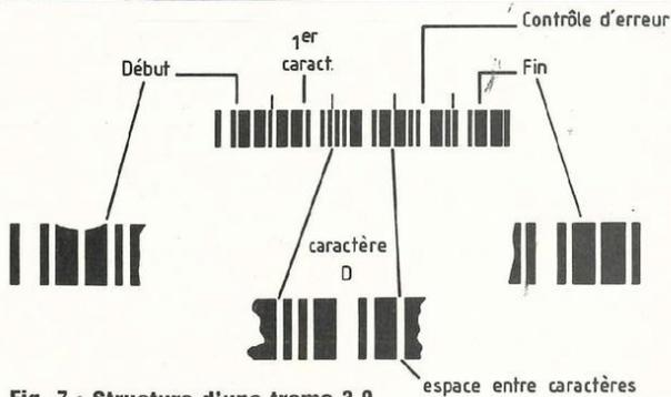
Fig. 7 : Structure d'une frame 3.9.
