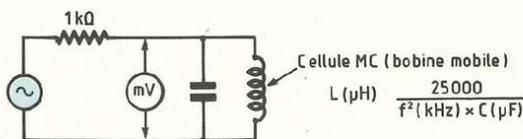
Fig. 3 : Montage permettant de connaître la valeur de l'inductance d'un phonolecteur à bobine mobile.
