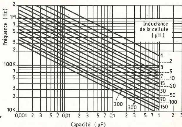
Fig. 4 : Abaque permettant de connaître la valeur de l'inductance des cellules à bobine mobile.
