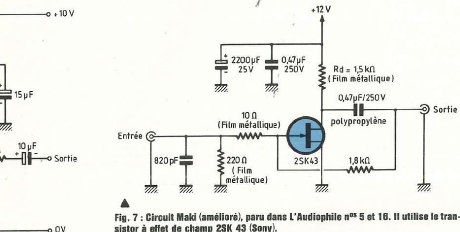
Fig. 7 : Circuit Maki (amélioré), paru dans L'Audiophile n°s 5 et 16. Il utilise le transistor à effet de champ 2SK 43 (Sony).
