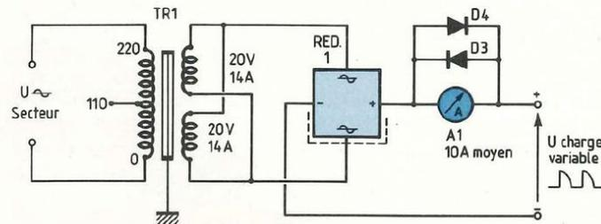
Fig. 9 : Circuit de charge et mesure du courant.
