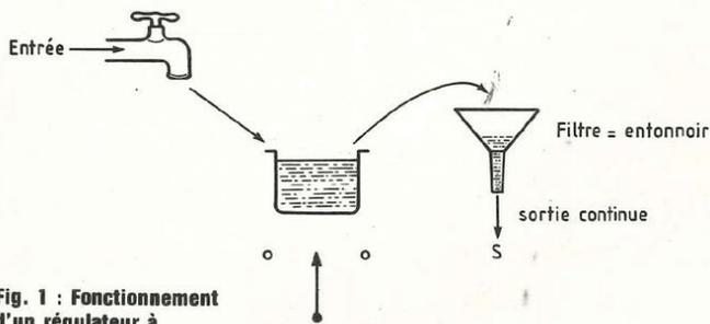
Fig. 1 : Fonctionnement d'un régulateur à découpage par analogie avec un système hydraulique. Fréquence CONSTANTE
