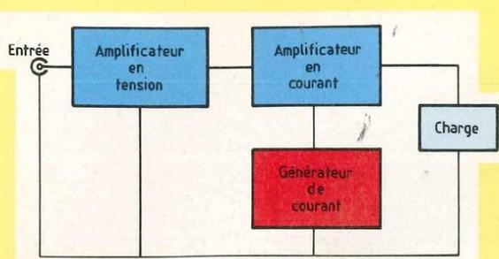
**Fig. 1 :** Synoptique de l'amplificateur. Il se compose de 3 parties :
