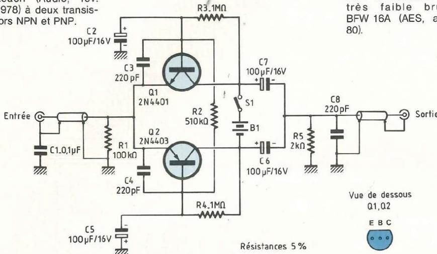
b) Circuit Philips utilisant le transistor à très faible bruit BFW 16A (AES, avr. 80).
