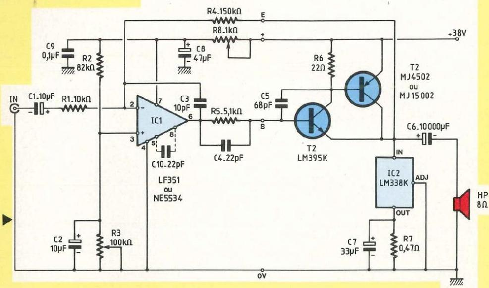
**Fig. 3 :** Le LM 395 n'est pas un transistor NPN classique, jugez-en un peu !
