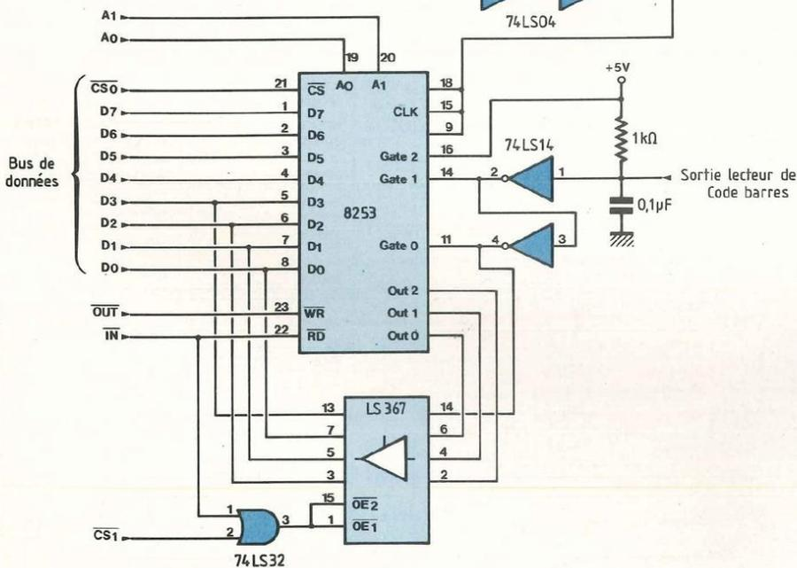
Fig. 8 : Interface lecteur de code barres Microprocesseur Z 80.
