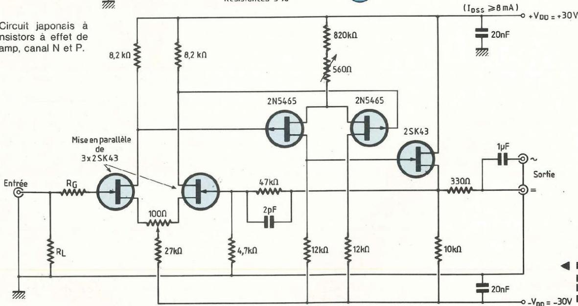
▲ Fig. 6 : Trois exemples de circuits pré-préamplificateurs pour cellules à bobine mobile. (D'après L'Audiophile n° 5 et n° 16).
