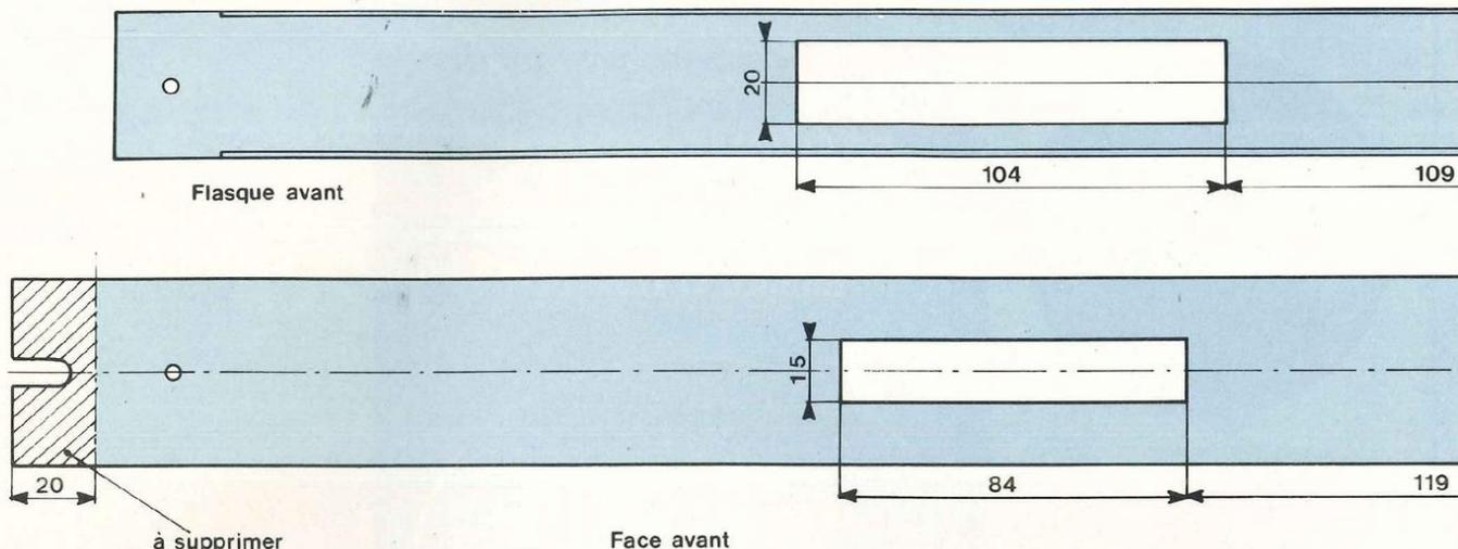
Fig. 4 (suite) : Perçages et découpes de la face avant.
