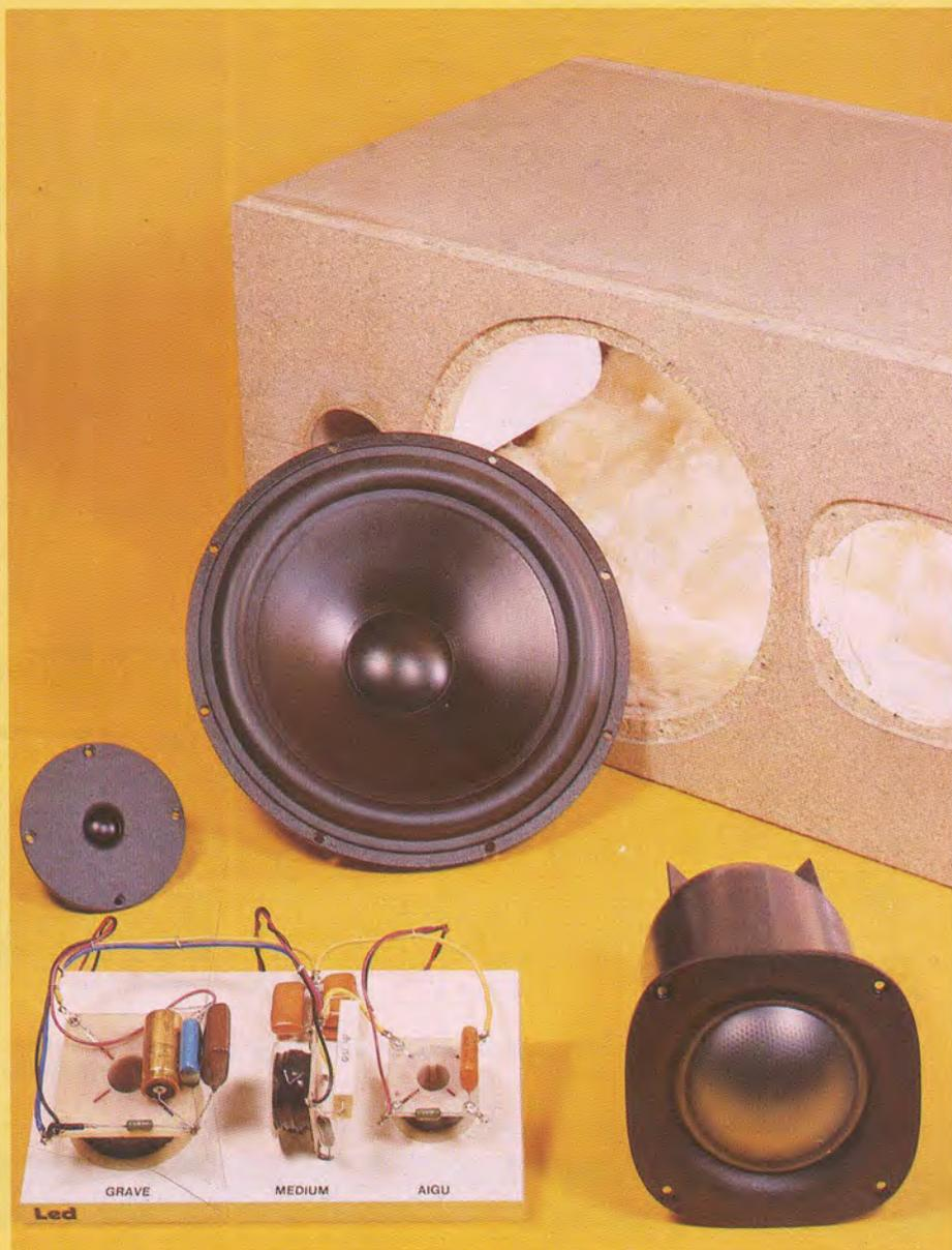
deux pointes, l'une à 50 Hz et l'autre à 800 Hz autour de 16  $\Omega$ , le module moyen restant à 8  $\Omega$ . Le rendement peut être considéré comme moyen, cependant avec un ampli de 25 W très dynamique et musical, il sera possible de se faire plaisir à un niveau d'écoute réaliste.
