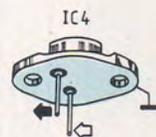
IC4 est à fixer sur un dissipateur.
