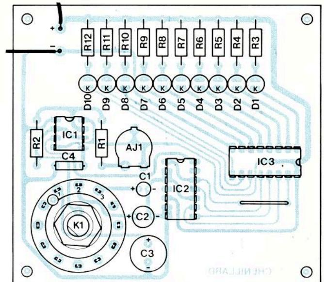
Fig. 4 : Mise en place des composants.
