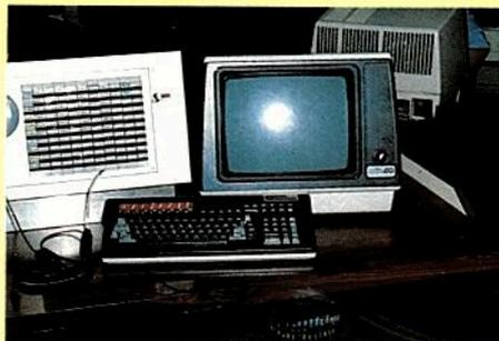
Fig. A : Salle appels (18). Une position d'exploitation. Les touches de fonction sont en rouge.
