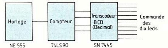
Fig. 1 : Synoptique de fonctionnement du chenillard.
