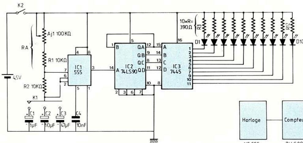
Fig. 2 : Schéma de principe du chenillard faisant appel à un timer, un compteur et un transcodeur.
