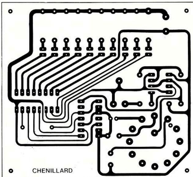
Fig. 3 : Implantation du chenillard à l'échelle 1.
