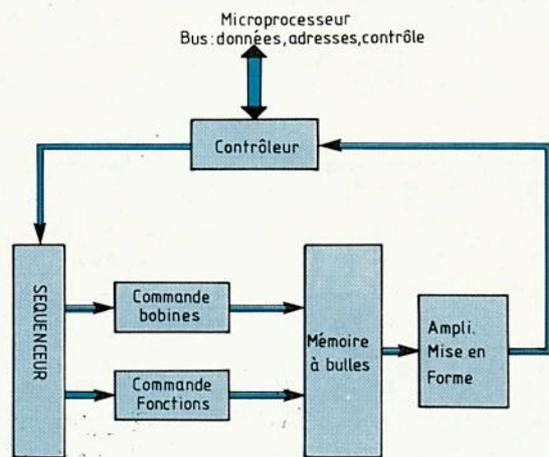
Fig. 5 : Mise en œuvre d'une mémoire à bulles.
