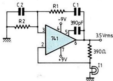
Fig. 4 : Circuit oscillateur B.F. utilisant le circuit intégré 741 et une lampe témoin faisant office de thermistance.
