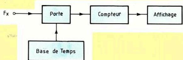
Fig. 1 : Synoptique du fréquencemètre BW01.
