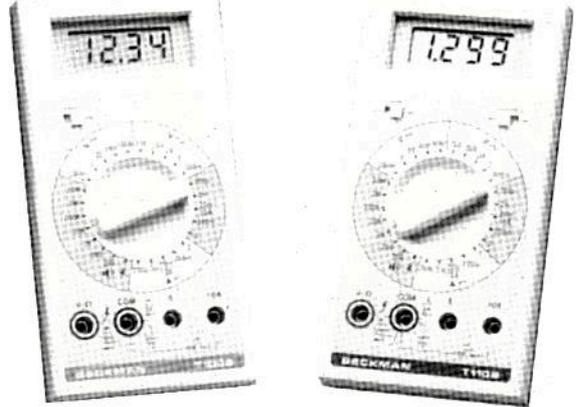
Deux multimètres de faible coût pour utilisation privée ou professionnelle. Contrôle de diodes, test de continuité sonore.
