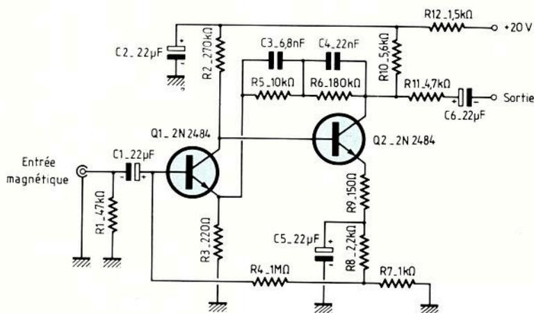
Fig. 2 : Préamplificateur RIAA faisant appel à deux transistors «faible bruit» 2N 2484.
