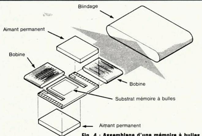
Fig. 4 : Assemblage d'une mémoire à bulles.
