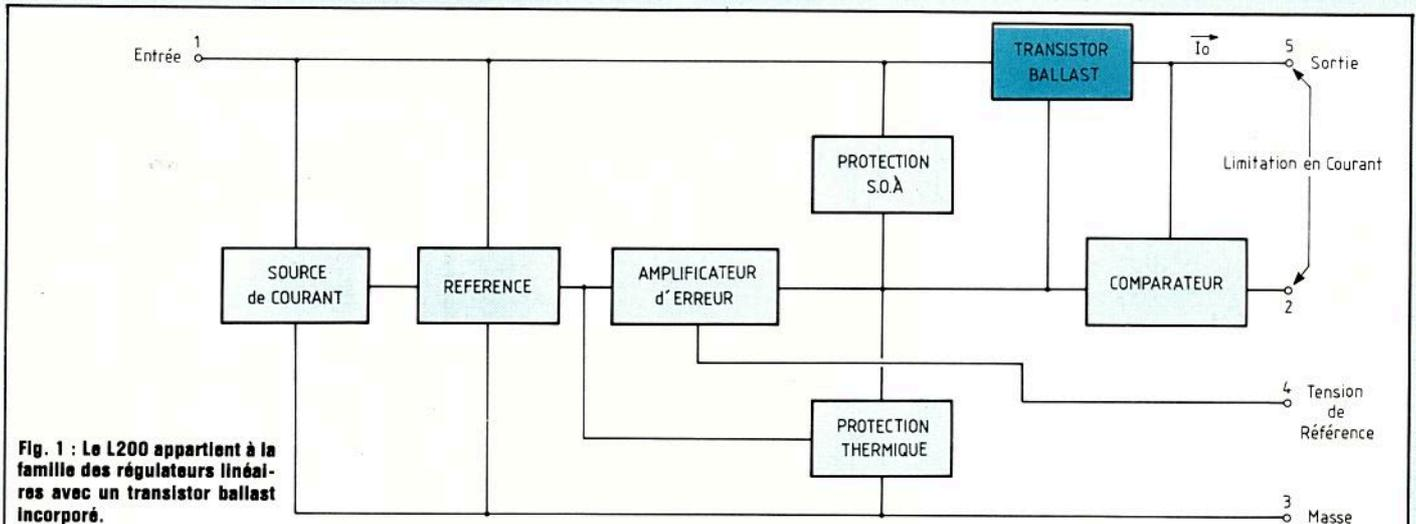
Fig. 1 : Le L200 appartient à la famille des régulateurs linéaires avec un transistor ballast incorporé.
