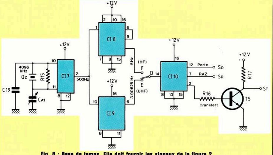
**Fig. 8 : Base de temps. Elle doit fournir les signaux de la figure 2.**
