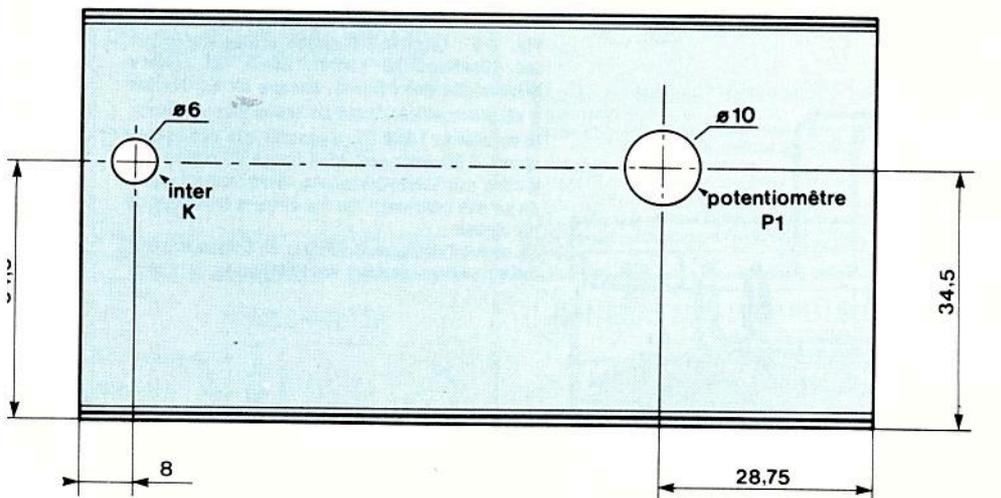
Fig. 5 : Perçages de la face avant.
