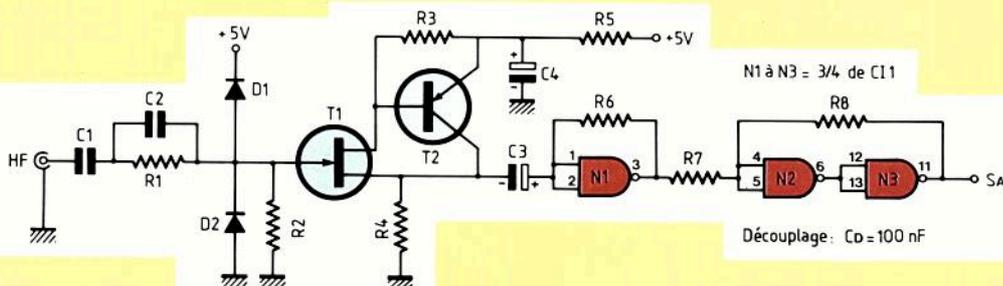
Fig. 4 : Etages d'entrée HF à impédance d'entrée élevée.
