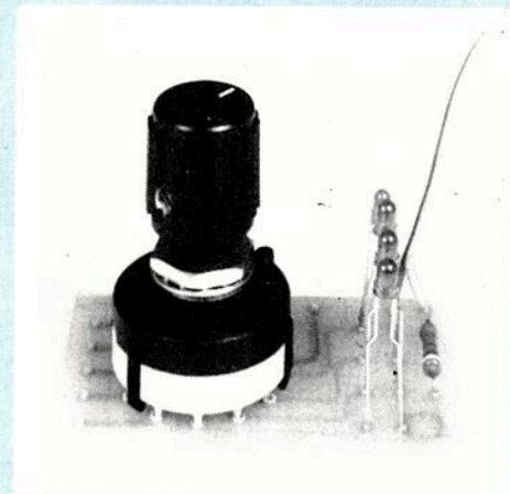
Commutation des entrées avec affichage par diodes leds.
