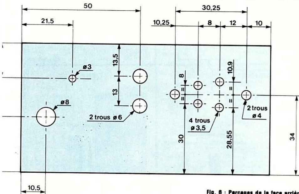
Fig. 6 : Perçages de la face arrière.
