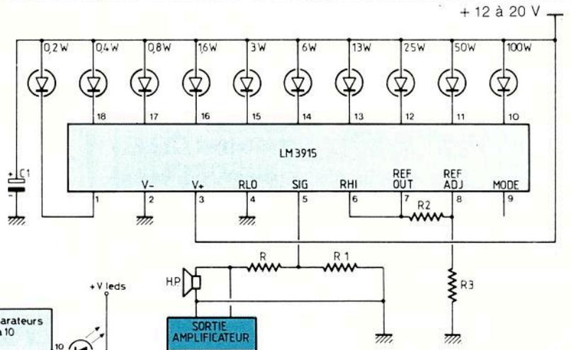
Fig. 1 : Schéma de principe du wattmètre.
