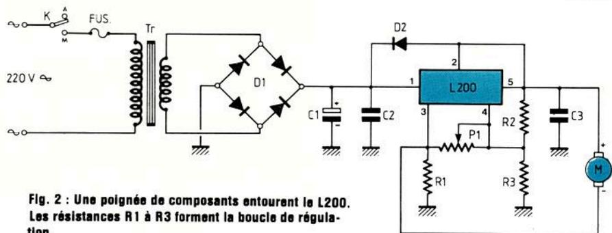
Fig. 2 : Une poignée de composants entourent le L200. Les résistances R1 à R3 forment la boucle de régulation.
