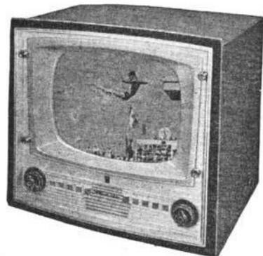
**RA4367.** Tube de 43 cm. Sélecteur 12 positions, dont 11 équipées, Luxembourg sur demande. 24 lampes + 3 germaniums. Commande automatique de gain. Comparateur de phase commutable. Anti-parasites son commutable. Anti-parasites images adaptable. HP elliptique 10-14 cm. Ebénisterie noyer et palissandre. H530-L610-P470 mm.
