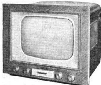
**T 1036 R.** Tube de 43 cm. Rotacteur 6 positions, dont 1 équipée. 15 lampes + germanium. Prise PU avec commutateur mettant hors circuit les lampes inutilisées. HP 19 cm. Ebénisterie façade noyer, acajou ou palissandre. H470-L560-P500 mm. Prix T.T.C. **115.013**
