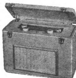
**Ambiance II.** Poste à piles 5 lampes (2-IT4, DK92, 1S5, 3Q4). Etage HF accordé. 3 gammes OC - PO - GO. Cadre ferroxcube et antenne télescopique. HP 12 cm. Tonalité réglable. 2 piles 1,5 V 300 mA et pile 90 V 19 mA. Position économique 250 mA et 12 mA. Possibilité d'alimentation secteur par bloc incorporable. Valise gainée H210-L300-P150 mm. Prix T.T.C. Paris, ss piles ni bloc-sect. **29.150**
