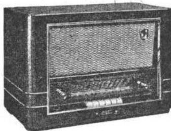
**Dauphiné-5637, 7 lampes (6BQ7, 6AJ8, 6BA6, 6AV6, 6BQ5, 6BX4, EM85).** Etage HF cascade accordé. 4 gammes OC-PO-GO-BE. Cadre à air blindé. Clavier 6 touches dont arrêt secteur et commutation PU. HP 19 cm. Tonalité réglable. Ebénisterie noyer. H350-L1580-P275 mm.
