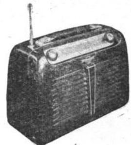
**Week-End,** poste piles-secteur 5 lampes + redresseur (DK92, IS5, 2-IT4, 3Q4, redr. Sélénox. Etage HF 3 gammes OC - PO - GO. Cadre incorporé et antenne télescopique. HP 90 V 14 mA. Tous courants continu ou alternatif. Coffret plastique bordeaux H2220-L305 P135 mm.
