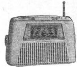
**Pygmy-Club.** Poste à piles 4 lampes (DK96, DF96, DAF96, DL96). 4 gammes OC1-OC2-PO-GO. 4 boutons poussoirs. Cadre ferroxcube et antenne télescopique. HP 10 cm. 2 piles 1,5 V 125 mA et pile 67,5 V 8,5 mA. Possibilité d'alimentation par bloc incorporable. Coffret 2 coquilles ivoire, vert, bordeaux ou
