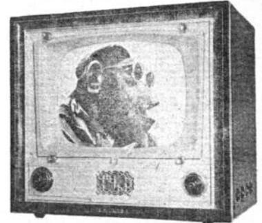
**TF1767A.** Tube de 43 cm. Sélecteur 12 positions, équipé pour les 11 canaux du standard français. 24 lampes + 3 germaniums. Commande automatique de gain. Circuit volant commutable. Anti-parasites son et image. Prise PU. HP elliptique 10-14 cm. Ebénisterie noyer H453-L615-P470 mm. Prix T.T.C. 151.160
