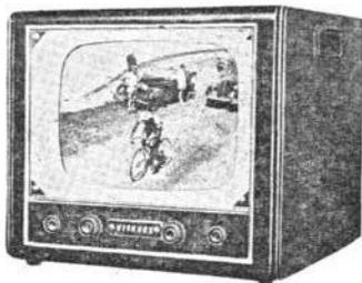
**143.** Tube de 43 cm. Rotacteur 6 positions dont 1 équipée. 16 lampes + germanium. MF inversées à circuits imprimés. Possibilité d'adjonction d'un anti-parasites son et image par technicien. HP 17 cm. Tonalité réglable. Prise pour télécommande. Ebénisterie noyer H450 - L520 - P520 mm. Prix T.T.C. 113.115
