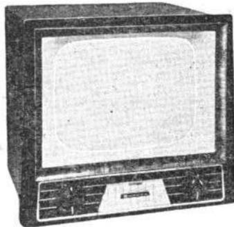
**TV 16-43.** Tube de 43 cm. aluminisé. Multicanal. Rotacteur 12 positions, équipé pour les canaux du standard français 819 lignes. 19 lampes + germaniums et 2 redresseurs secs. Bande passante 10 Mc/s. Possibilité d'adaptation d'un préamplificateur. Comparateur de phase. HP 19 cm. Puissance 3 W. Alternatif 110/125 V, 50 c/s, 190 VA. Ebénisterie noyer ou acajou, décor laiton poli. H 490 - L 540 - P 580 mm, 40 kgs.
