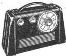
**Transivox.** Poste à piles à 8 transistors : 4 transistors haute fréquence spéciaux, 1 diode au germanium, 4 transistors basse fréquence : deux OC71, deux OC72 en étage final push-pull class B. Cadre incorporé PO-GO sur ferrite. Superhétérodyne. Alimentation totale par 4 piles torche 1,5 V. Dimensions : 60x140x220 mm.
