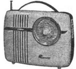
**P1**. Poste à piles 4 lampes (DK96, DF96, DAF96, DL96). 3 gammes PO-GO-OC. 4 boutons poussoirs dont arrêt. Cadre ferrite et antenne télescopique. HP 9 cm. 2 piles 1,5 V 100 mA et pile 67,5 V 8mA. Possibilité d'alimentation HT secteur par bloc incorporable. Plastique ivoire, corail ou vert.
