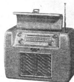
**Mistral-Métropole.** Poste piles-secteur 5 lampes + redresseur (DK92, 1T4, 1L4, 1S5, 3Q4, redresseur). 3 gammes OC - PO - GO. Cadre ferroxcube et antenne télescopique. HP 12 cm. 2 piles 4,5 V 50 mA et pile 90 V 18 mA. Position économique 9 mA. Alternatif. Commutateur 4 directions : secteur, arrêt, normal, économique. Gainé toile coloris divers. H206-L266-P130 mm.
