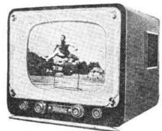
**431.** Tube de 43 cm. Rotacteur 6 positions, dont 1 équipée. 16 lampes + germanium. MF inversée à circuits imprimés. HP 17 cm. Tonalité réglable. Prise pour télécommande. Ebénisterie noyer. H450-L520-P520 mm.
