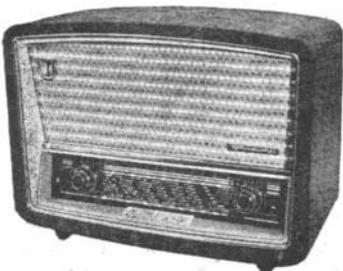
**RA 567 AM/FM.** 8 lampes (ECC85, ECH81, EF89, EABC80, EL84, UL84, EZ81, EM80). 4 gammes GO - PO - OC - FM. Cadre micro-
