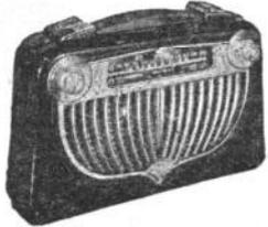
**Fox**. Poste à piles 4 lampes (DK96, DF96, DAF96, DL96). 3 gammes OC (40-50 m) - PO - GO. Cadre ferroxcube. Antenne télescopique adaptable. HP 12 cm. 2 piles 1,5 V 125 mA et 67,5 V 9 mA. Possibilité d'alimentation secteur par bloc incorporable. Polystyrène ivoire ou aubergine, H160-L240-P65 mm. Prix T.T.C., piles comprises **14.962**
