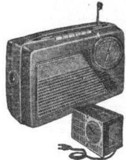
**Pygmy-Golf.** Poste à piles 6 lampes (DK96, 2-DF96, DAF96, DL96, DM70). Etage HF 6 gammes OC1-OC2-OC3-OC4-PO-GO. 6 boutons poussoirs. Cadre ferroxcube et antenne télescopique. HP elliptique 10-14 cm. 3 piles 1,5 V 175 mA et pile 90 V 11 mA. Position économique 8,5 mA. Possibilité d'alimentation secteur par adjonction d'un bloc incorporable. Coffret 2 coquilles ivoire, vert, bordeaux ou gris perle, H195-L280-P98 mm.
