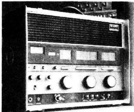
La sensibilité FM est de 0,8  $\mu$ V, la sensibilité ondes courtes 1  $\mu$ V, celle des grandes ondes 41  $\mu$ V et celle des petites ondes 25  $\mu$ V. La puissance de sortie est de 3 watts.
