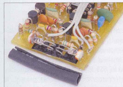
Constitution des photo coupleurs, un film adhésif noir empêche la pénétration de la lumière au travers du circuit imprimé. Les boucles des sorties des diodes permettent un réglage de leur position par rapport à la photorésistance (équilibre)
