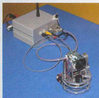
Cette tourelle gyrostabilisée sera la charge utile du drone électrique de Bertin
