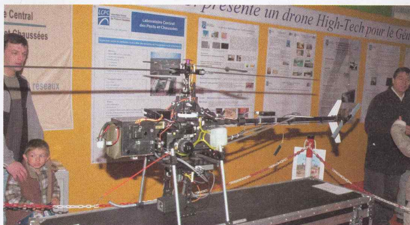
Un hélicoptère que l'on apprend à piloter en une matinée... Ces commandes sont assistées et il peut emmener une charge pour l'inspection d'ouvrages d'art. Conçu pour le Laboratoire Central des Ponts et Chaussées
