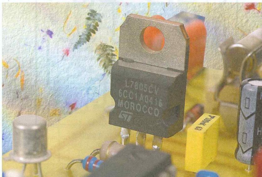
Le régulateur ne dispose pas de dissipateur
