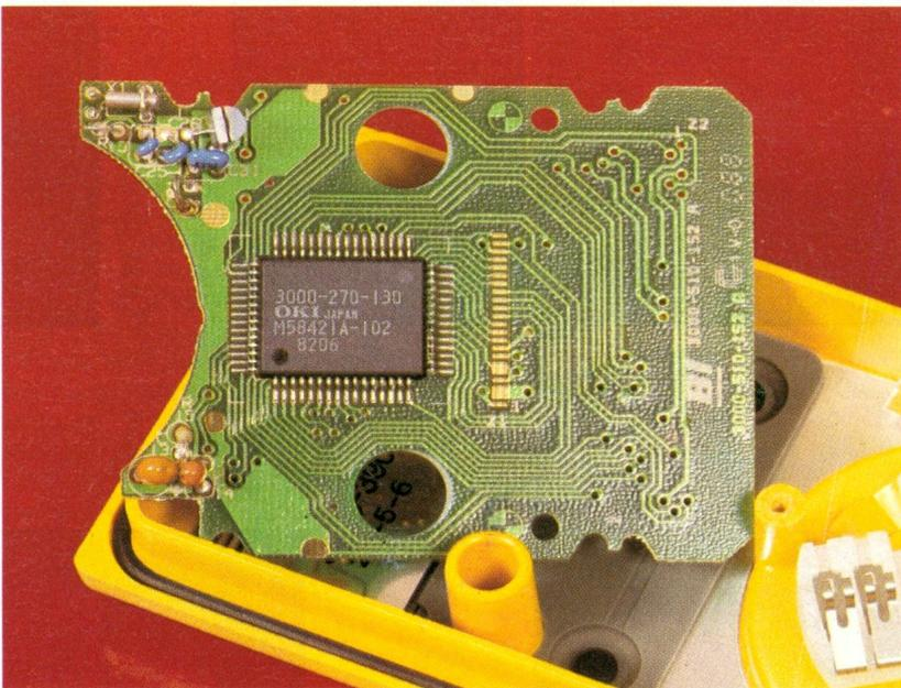
Photo 3. – Vue du circuit intégré pilotant l'appareil.
