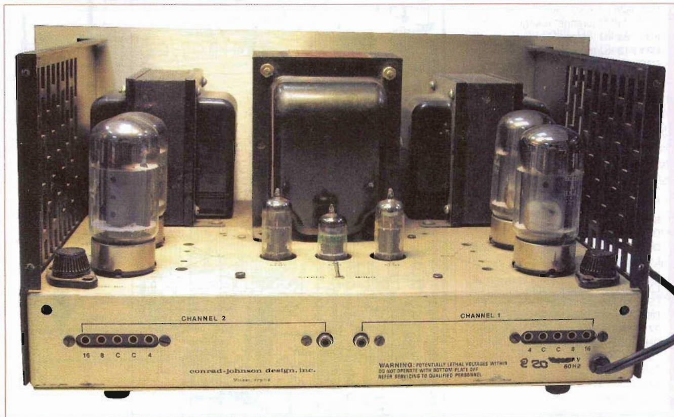
L'analyse des célèbres circuits électroniques à tubes faisant partie des applications pratiques de notre série de cours, nous allons étudier, en deux numéros consécutifs, le MV75 de Conrad Johnson. Lequel constitue une belle illustration de notre cours n°26 (EP n°308) qui traitait des amplificateurs fonctionnant en ultra-linéaire.
