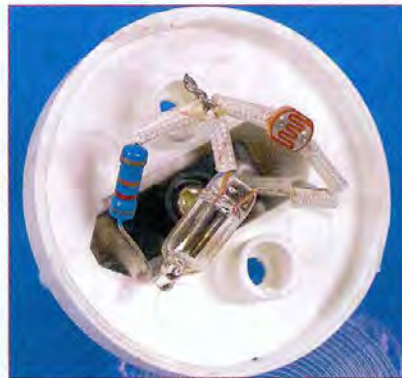
Intérieur du boîtier d'origine contenant une veilleuse néon et une cellule photorésistante
