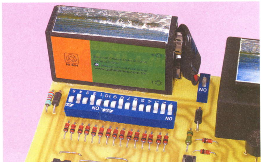
Le bloc DIL de 15 interrupteurs permet d'établir les liaisons de programmation
