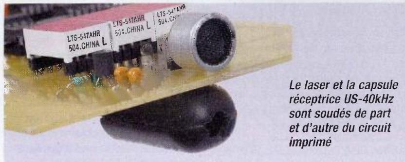
Le laser et la capsule réceptrice US-40kHz sont soudés de part et d'autre du circuit imprimé
