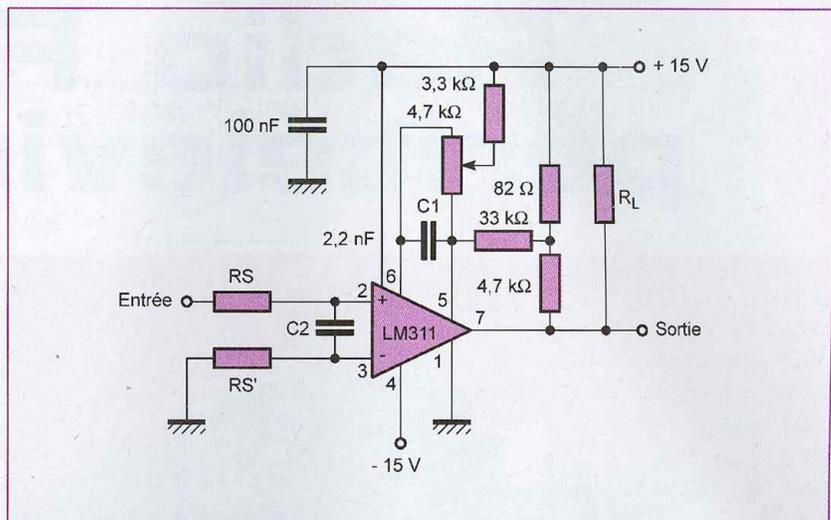
9 Schéma d'application type du LM311
