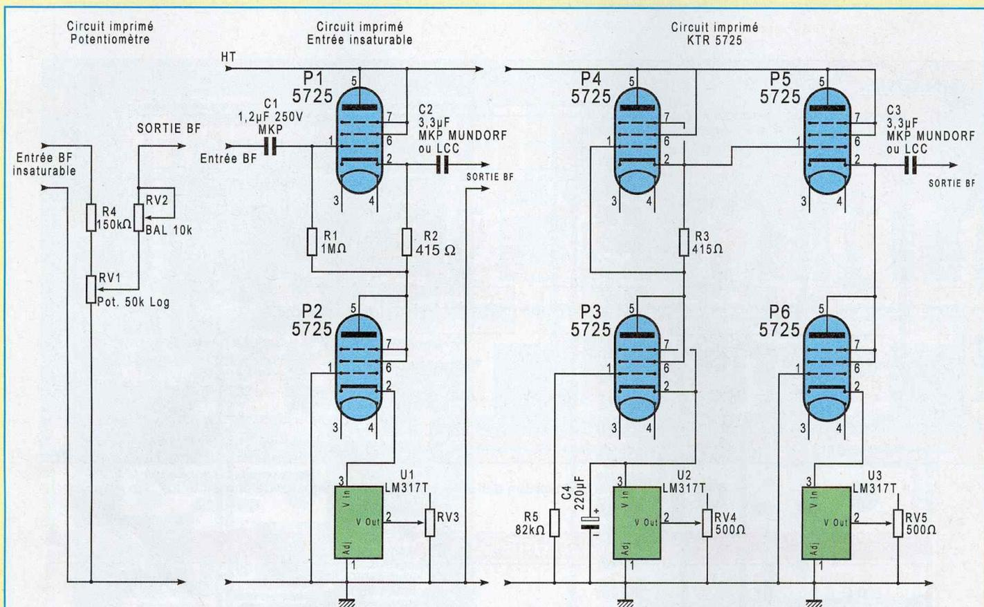
Figure 12 : Schéma général du préamplificateur KTR5725
