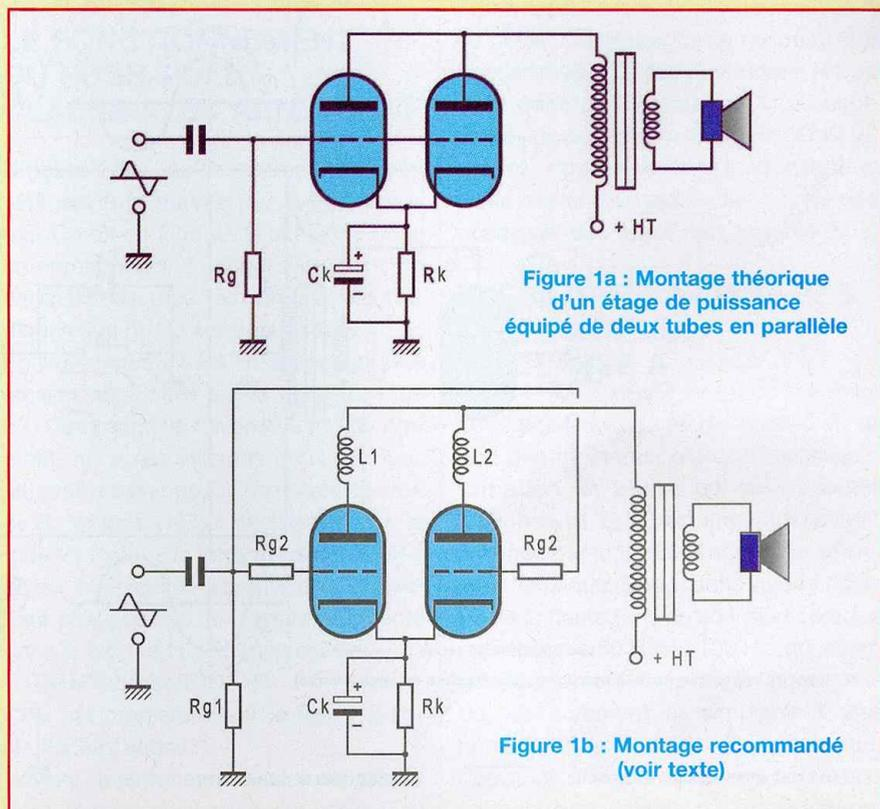
Figure 1a : Montage théorique d'un étage de puissance équipé de deux tubes en parallèle
