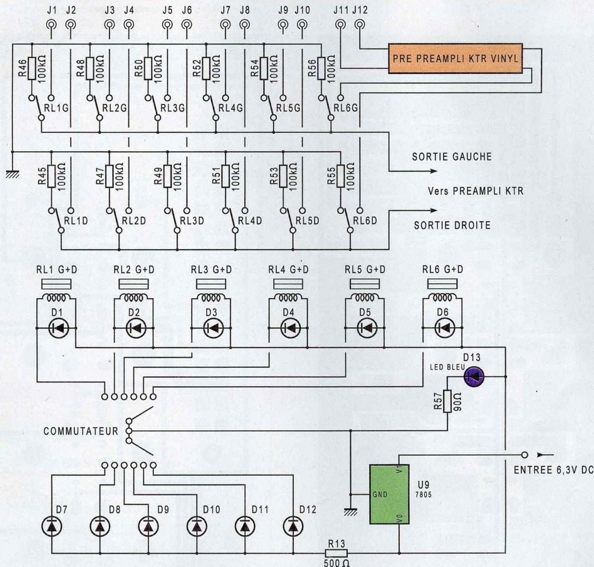
Figure 7 : Circuit de commutation pour six entrées
