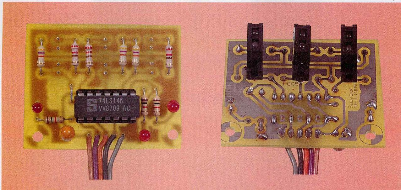
**Cet article explique comment réaliser une carte permettant de détecter une ligne contrastée par rapport au sol. Elle pourra être utilisée pour réaliser un robot suiveur de ligne.**
