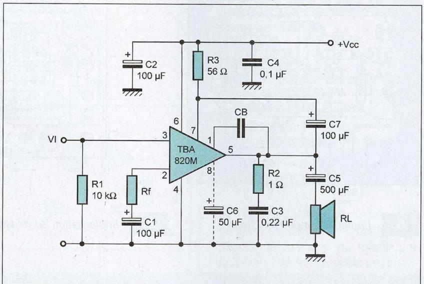
12 Schéma d'application avec HP relié à la masse
