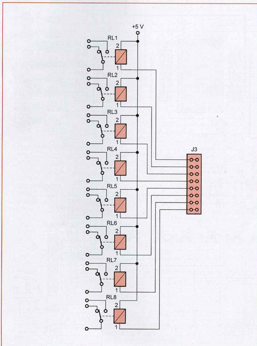
simples entrées/sorties, nous utilisons deux circuits intégrés de type ULN2803A aux sorties desquels sont connectées des leds. Huit relais électromécaniques sont présents sur la platine. Un connecteur 8 points permet leur alimentation (**figure 5b**).
