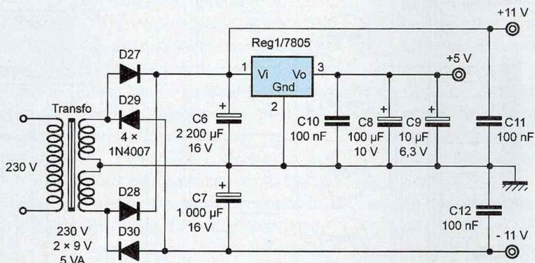
valeur de ces résistances d'équilibrage. Le montage est alimenté par un transformateur 230 V/2 x 9 V dont le point milieu est relié à la masse du montage. On obtient ainsi, après redressement, les deux tensions symétriques +11 V et -11 V nécessaires au fonctionnement des amplificateurs IC3 et IC4 (figure 3).
