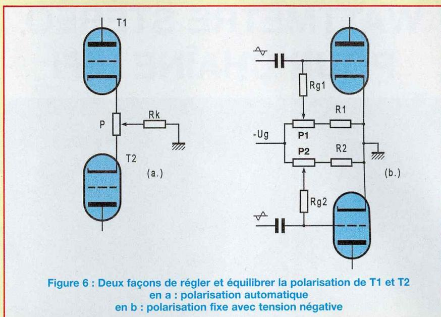
Figure 6 : Deux façons de régler et équilibrer la polarisation de T1 et T2
