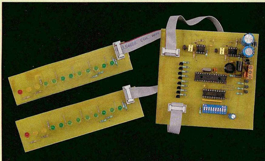
Le but de ce montage est d'indiquer, à l'aide de vumètres à leds, la puissance efficace reçue (à impédance fixe) par les enceintes d'une chaîne hi-fi. Grâce à l'usage d'un microcontrôleur PIC16F876, il est possible de programmer la puissance correspondant à la déviation à pleine échelle du vumètre, de 1 W (voire 0,5 W) à 255 W par pas de 1 W.
