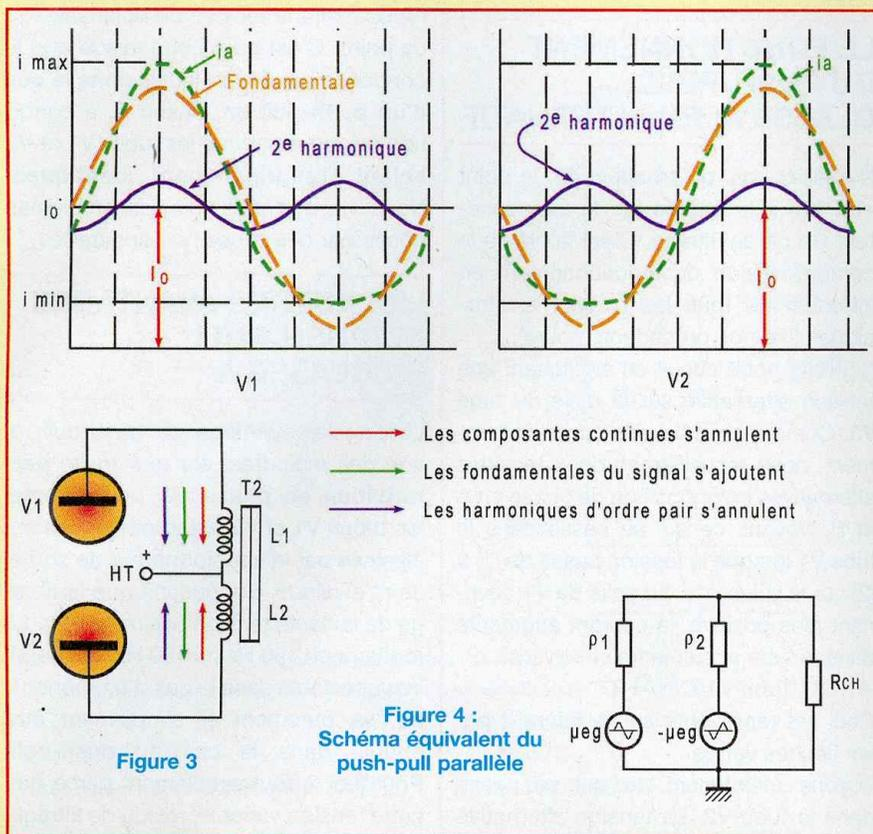
Il rend ce montage imbattable en terme de distorsion en utilisant des triodes de puissance ou des tétrodes à faisceau dirigé. Ces deux types de tubes génèrent, en effet, une majorité d'harmoniques pairs, contrairement aux pentodes dont les harmoniques impairs sont dominants.
