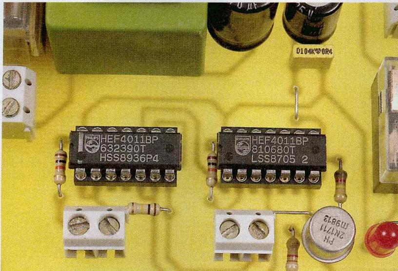
Contrairement à l'électronique analogique dont les niveaux de potentiel peuvent prendre n'importe quelle valeur comprise entre le zéro volt et le maximum du potentiel d'alimentation d'un montage, les fondements de l'électronique logique reposent sur l'existence exclusive de deux valeurs : 0 ou 1, qui correspondent respectivement au zéro volt et au potentiel maximum
