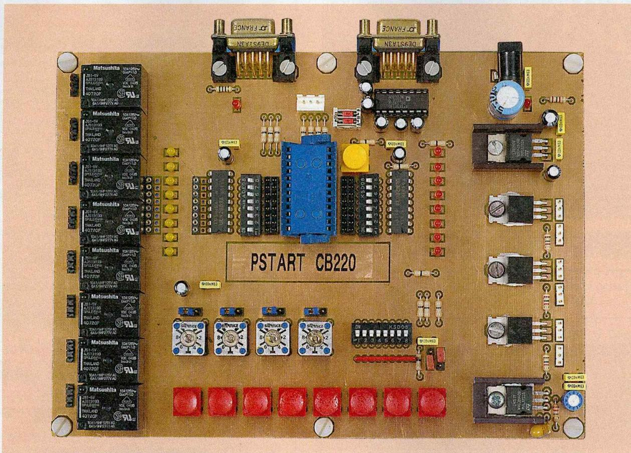
Le CB220 est un PLC présentant la particularité de travailler en vrai multitâches. Il est en effet doté d'un interpréteur BASIC très rapide ainsi que d'un LADDER travaillant en parallèle. Nous vous proposons aujourd'hui la réalisation d'une platine de développement pour l'élaboration et la mise au point des programmes permettant sa mise en œuvre.
