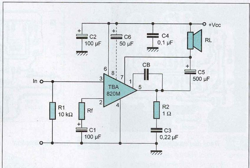
11 Schéma d'application avec HP relié au +Vcc
