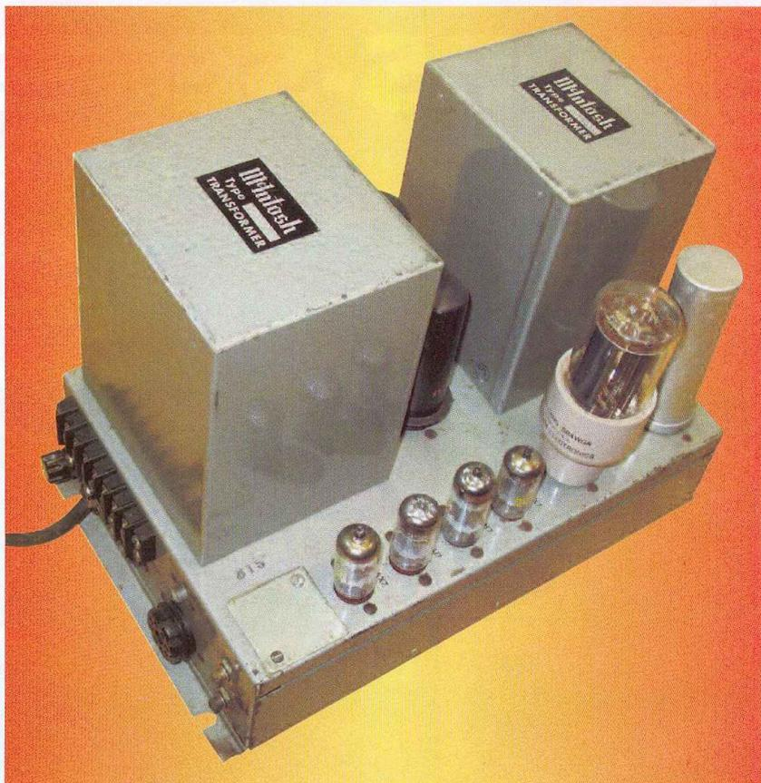
**D**es différences ? Uniquement au plan de la construction et, en particulier, les transformateurs d'alimentation et de sortie dont les connexions sont réalisées sur perles en verre (voir photo A, connexions directes par fils pour les versions grand public).
