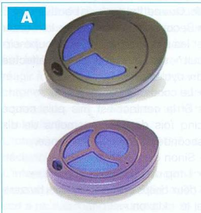
◆ **L'émetteur** est du type porte-clé. C'est un HCS-TX2 (photo A) de chez Aurel. Avec une à trois voies disponibles, il nous faudra ici au moins deux boutons pour exploiter toutes les possibilités du montage. Il émet sur la bande des 434 MHz, un code binaire à chaque fois différent et issu de l'algorithme à haute sécurité Keeloq (de Microchip). Chaque boîtier est en fait doté d'un numéro de série unique de 28 bits, d'une clé de
