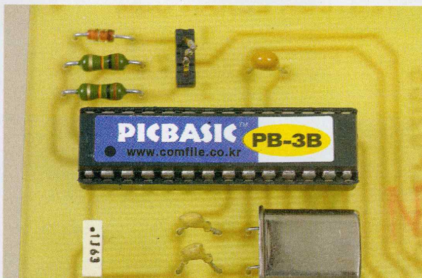
Utilisation du PICBASIC PB-3B
