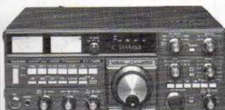
**FT 726R.** Emetteur-récepteur 144/432MHz. Duplex intégral VHF/UHF. Tous modes. 10W. Alimentation secteur et 12V DC. Récepteur satellite en option. 432MHz en option.
