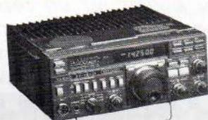
**FT 757GX.** Récepteur à couverture générale. Emetteur bandes amateurs. Tous modes AM/FM/SSB/CW/FSK. Alim. 13.4V DC. 100W. Dimensions: 238x93x238mm. Poids: 4,5kg. Option interface de télécommande par ordinateur (AppleII).
