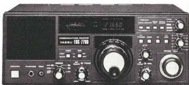
FRG 7700 Récepteur à couverture générale de 150 kHz à 30 MHz. AM/FM/SSB/CW. Affichage digital. Alimentation 220 V. En option: 12 mémoires et 12V. Egalement: FRA 7700 : antenne active. FRT 7700 : boîte d'accord d'antenne. FRV 7700 : convertisseur VHF.
