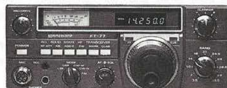
FT-77 Émetteur/Récepteur toutes bandes décamétriques BLI/BLC - CW et FM. 200 W PEP.
