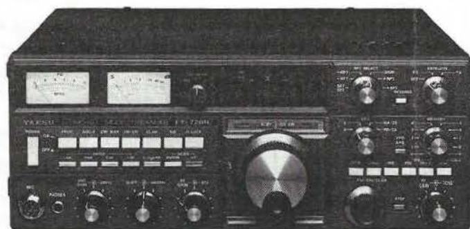
FT 726R Emetteur/récepteur tous modes, 144/432 MHz, 10 W, alimentation secteur et 12 V. Récepteur satellite en option. 432 MHz en option.
