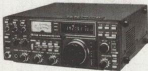
**IC 751**: transceiver à couverture générale de 2° génération. Tous modes. 32 mémoires. 2 VFO'S. Réception, 4 changements de fréquences. Possibilité d'alim. 220 V incorporée. Livré complet, prêt à fonctionner, micro compris.
