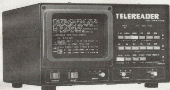
**CWR 675EP — TELEADER** — Décodeur RTTY/CW/ASCII, moniteur 5 pouces, identique au CWR 675E mais avec imprimante thermique incorporée.
