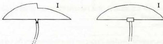
Les deux conséquences notables de ce phénomène sont une distorsion du lobe de rayonnement et l'apparition de courants H.F. sur la gaine extérieure du câble coaxial.
