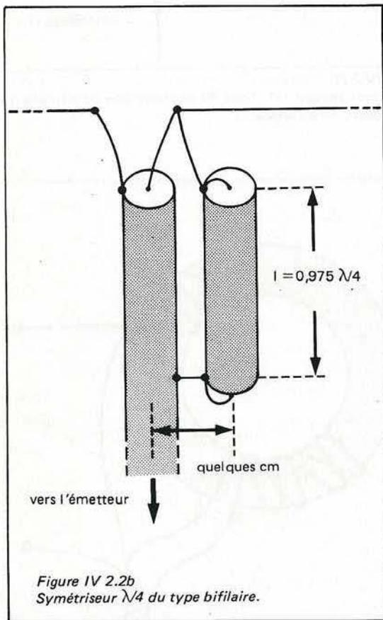
La ligne  $\lambda/4$  qui sert de symétriseur est du type bifilaire dans l'exemple ci-dessus ; la figure IV 2.2c donne un balun comparable mais à ligne coaxiale. La jupe  $\lambda/4$  entourant le câble coaxial se comporte comme une ligne  $\lambda/4$  court-circuitée à son extrémité, elle présente ainsi une impédance infinie à la fréquence de travail et bloque les courants qui tenteraient de circuler sur la gaine.
