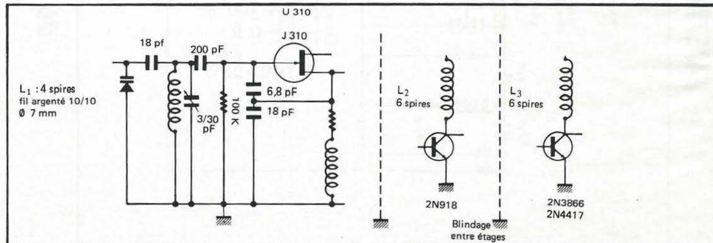
Figure 13 - Dimensionnement VCO et selfs pour 88 à 108 MHz
