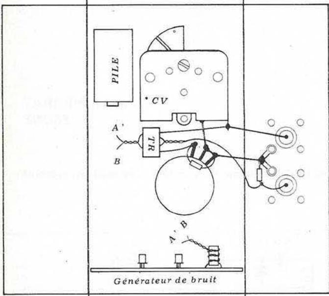
NOTA : Le transformateur est dessiné horizontalement pour plus de clarté. En fait, il est monté verticalement entre le CV et le potentiomètre.
