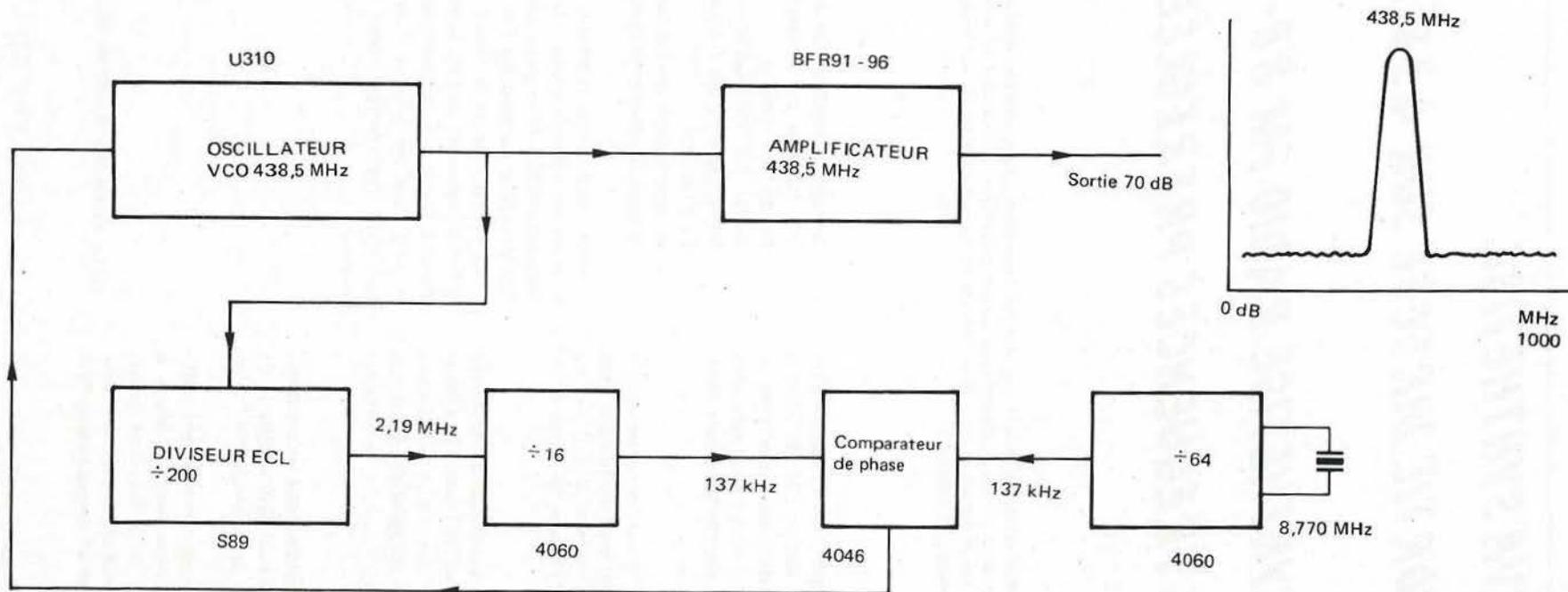
$$F_{\text{sortie}} = N \times \text{Fréquence}$$
