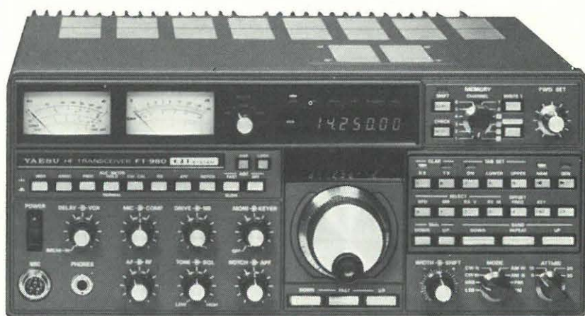
FT 980 * Récepteur 150 kHz à 30 MHz. Emetteur bandes amateurs. 120 W HF. Tout transistor.
