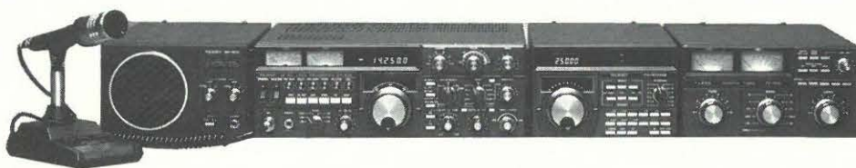
FT 980 * Récepteur 150 kHz à 30 MHz. Emetteur bandes amateurs. 120 W HF. Tout transistor.
