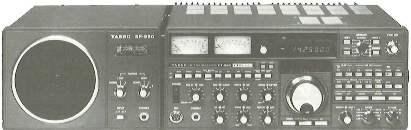
**FT 980\*** – Récepteur 150 kHz - 30 MHz. Emetteur bandes amateurs. 120 W HF.
