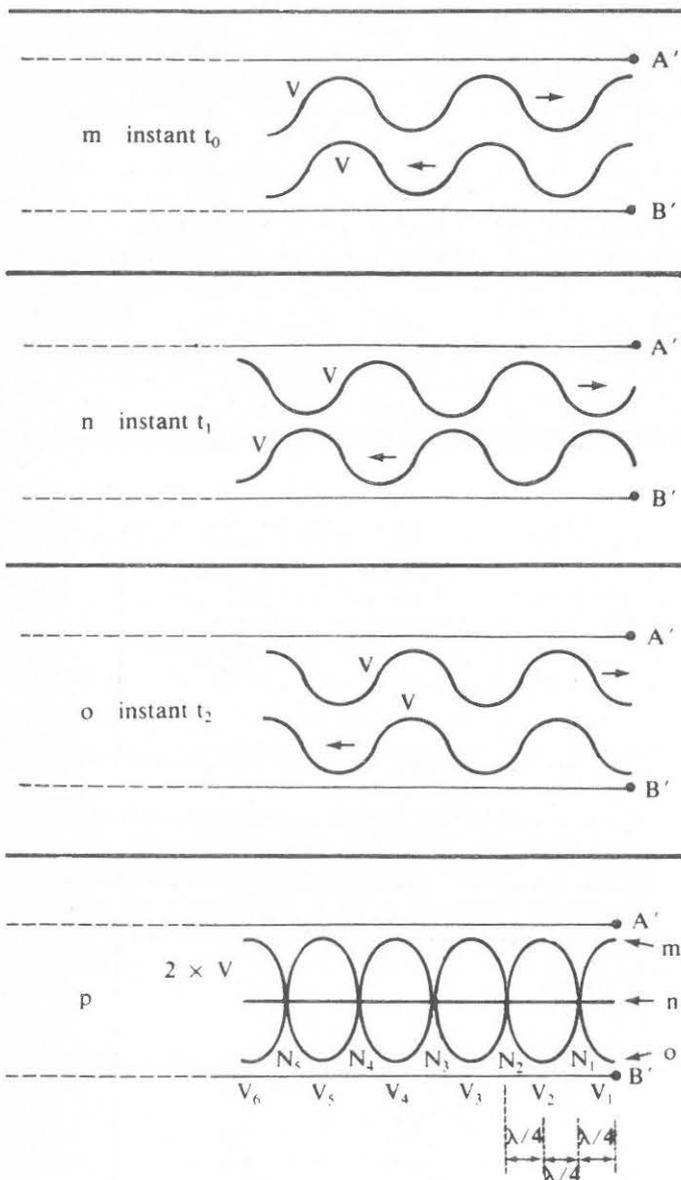
Fig. B.3.1 *m, n, o et p.* Allure des ondes directe et réfléchi à trois instants successifs  $t_0, t_1$  et  $t_2$  (ligne ouverte). En bas, la tension obtenue en ajoutant algébriquement point par point ces tensions directe et réfléchi.
