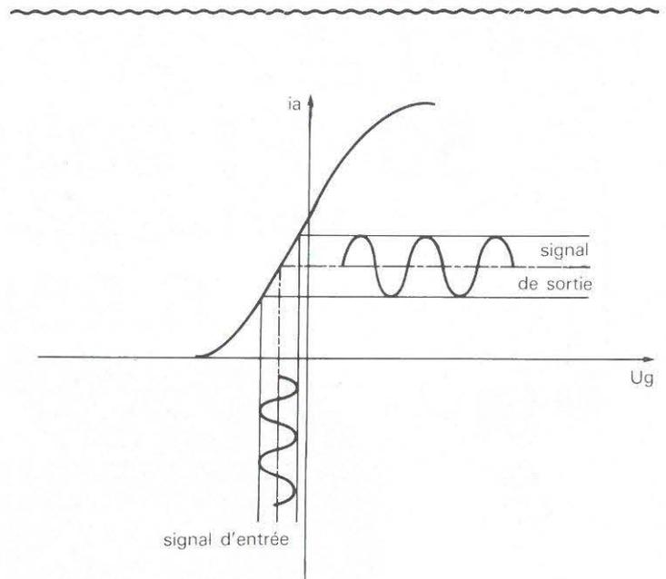
En classe A, le signal d'entrée est amplifié sans distorsion. Le courant de repos du tube est très important. Le rendement est de 30 à 40 %.
