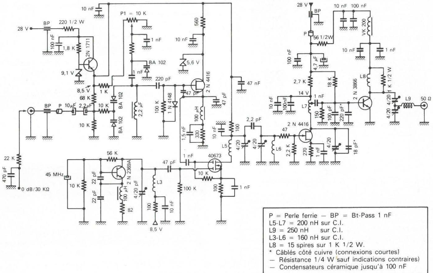
Fig. 2. Pilote 101 MHz à mélange
