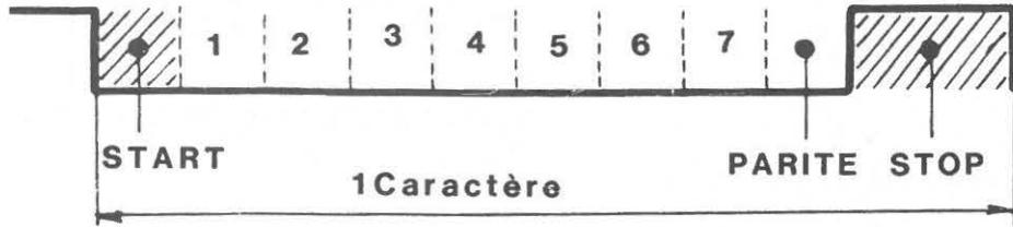
Nous avons donc 2 bits à 1 si bien que le bit de parité pair passe à 1. Il est important de noter que l'ordre de transmission des bits (c'est aussi valable pour le baudot) est inversé par rapport à l'écriture puisqu'on transmet d'abord le bit de poids faible.
