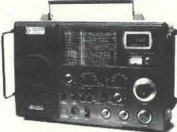
**Nouveau récepteur portable, permettant la réception de 12 gammes d'ondes ; 6 gammes en modulation d'amplitude et 6 gammes en modulation de fréquence :** certaines de ces fréquences sont particulièrement intéressantes, bandes aviation, bandes marine, etc.
