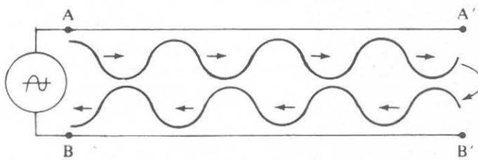
Fig. B.3.1l. Sur la ligne ouverte circulent simultanément deux ondes, l'onde directe et l'onde réfléchie.
