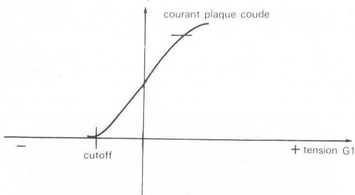
A une certaine valeur négative de G1, le tube se met à conduire et le courant plaque apparaît. En polarisant G1 de façon plus positive, le courant plaque croît jusqu'au coude. Il faudra rester dans la plage linéaire du tube.
