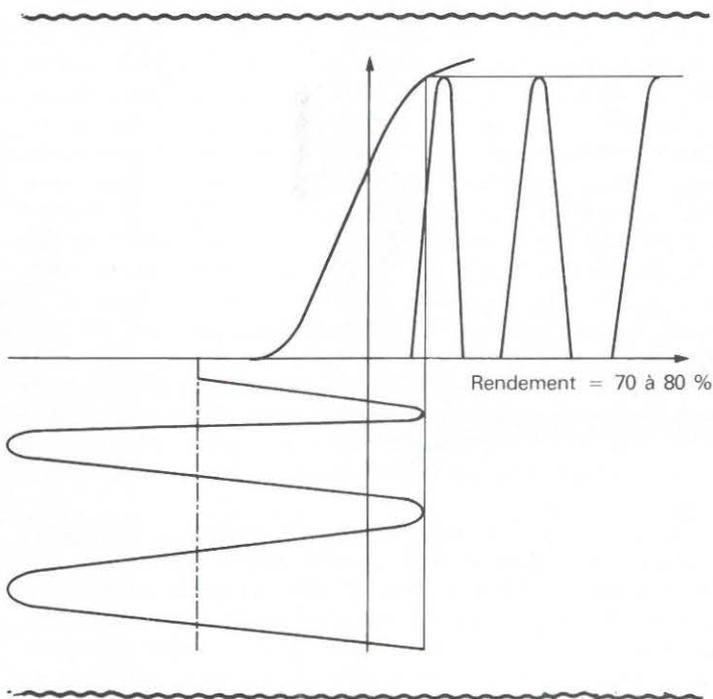
La distorsion est dans cette classe très importante et on ne l'utilise que pour les amplificateurs FM ou pour les étages multiplicateurs.
