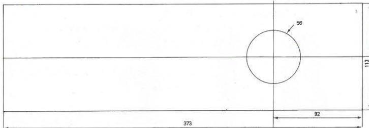
DÉTAIL MÉCANIQUE DU DESSOUS DE L'AMPLI
