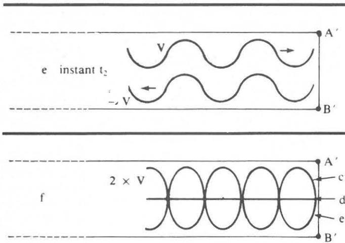
Fig. B.3.2c, d, e et f. Allure des ondes directe et réfléchiée à trois instants successifs  $t_0$ ,  $t_1$  et  $t_2$  (ligne en court-circuit). En bas, la tension obtenue en ajoutant algébriquement point par point ces tensions directe et réfléchiée.
