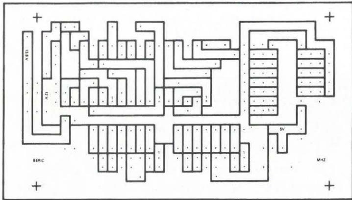
Fig. 7. SYSTEME D'AFFICHAGE DU CANAL CÔTÉ CUIVRE.
