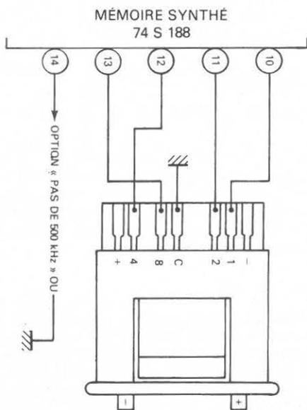
C'est pour cela que l'on trouve 8 résistances de 4,7k entre les sorties de la mémoire et le +12V. Sur la mémoire du synthé, ces résistances sont inutiles car incluses dans le MC 145 151. En plaçant une résistance (2,2 à 5,6k) entre l'entrée ou la sortie et le plus, on obtient un état bas à zéro et un état haut équivalent, en général, au potentiel alimentation.
