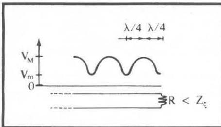
Fig. B.3.3d. Ondes stationnaires fournies par le battement d'une onde directe  $V_d$  et d'une onde réfléchiée  $V_r$  dans le cas où  $R > Z_c$ ; on a un ventre de courant sur la charge (nœud de tension).
