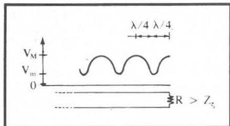
Fig. B.3.3c. Ondes stationnaires fournies par le battement d'une onde directe  $V_d$  et d'une onde réfléchiée  $V_r$  dans le cas où  $R > Z_c$  : on a un ventre de tension sur la charge (nœud de courant).
