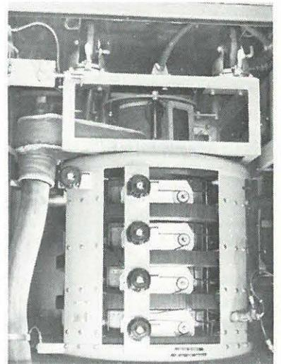
*Le tout est posé sur un petit charriot à roulettes. Puis il est placé à l'intérieur de la baie de l'émetteur. Il ne reste plus que les différents branchements à faire. Ensuite le Klystron est prêt à fonctionner. On voit en face les 4 molettes de réglage des cavités.*
