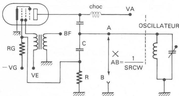
Fig.2. Tube à réactance
