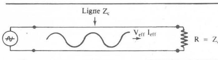
Fig. B.2.5a. Il faut placer en bout de ligne une charge résistive égale à l'impédance caractéristique de la ligne.
