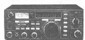
**IC 730**, Émetteur-récepteur, bande amateur, double VFO incorporé.
