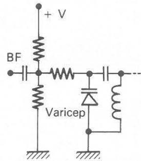
Fig.4b. Modulation de la zone de déplétion par un signal alternatif
