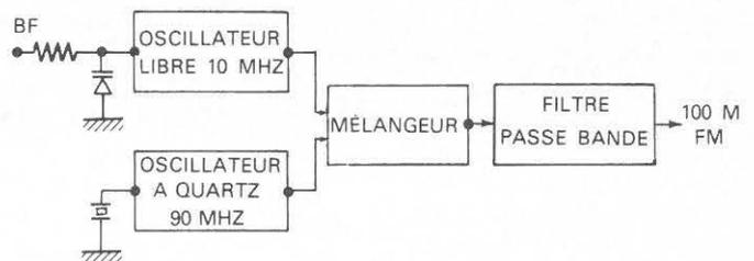
Fig.6. Pilote à mélange de fréquence
