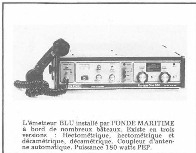
L'émetteur BLU installé par l'ONDE MARITIME à bord de nombreux bateaux. Existe en trois versions : Hectométrique, hectométrique et décimétrique, décimétrique. Coupleur d'antenne automatique. Puissance 180 watts PEP.
