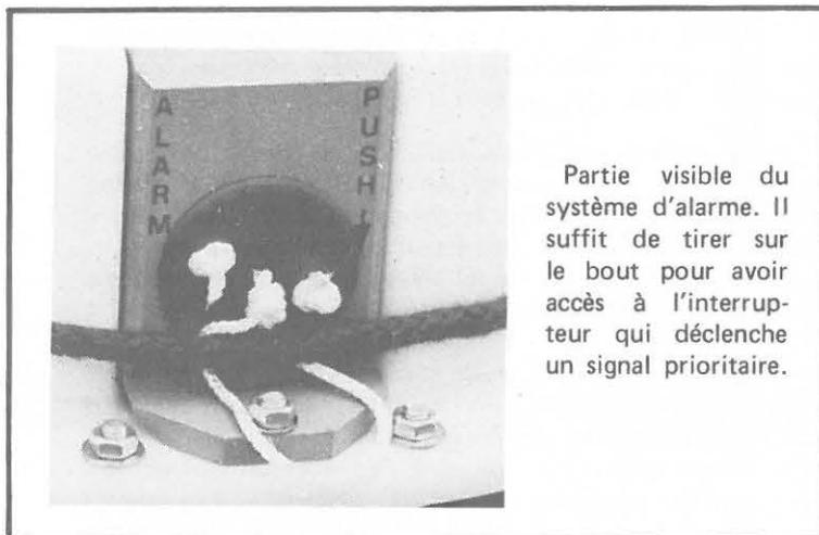
Partie visible du système d'alarme. Il suffit de tirer sur le bout pour avoir accès à l'interrupteur qui déclenche un signal prioritaire.
