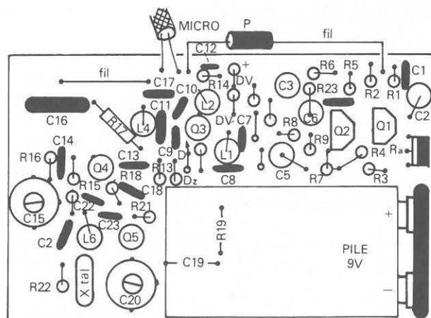
Fig. 9. Implantation (L'électrode + des diodes est l'anode)
