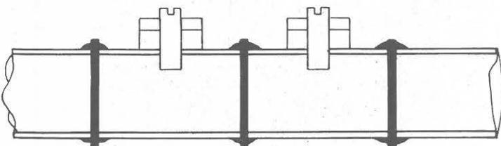
Ne pas oublier d'éliminer avant la fixation *définitive* des éléments la limaille de laiton qui se trouve dans les guides et qui a pour origine les mille et une rotations des vis au moment des réglages.
