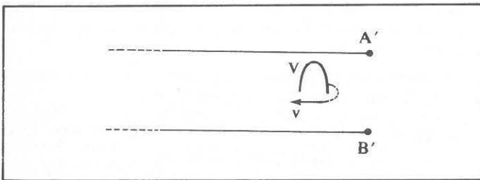
Fig. B.3.1c. L'impulsion V un instant après son arrivée en A'B' ; elle se déplace maintenant vers la gauche, et toujours à la vitesse  $v$ .
