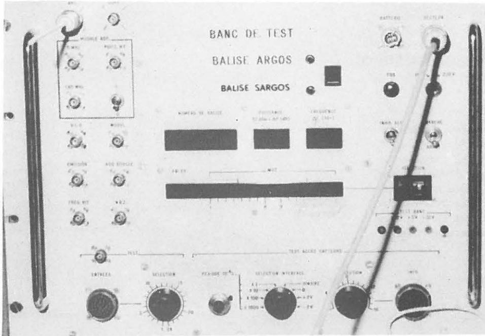
Ci-contre l'appareil qui servait, à St Malo, à effectuer les essais de fonctionnement des balises Argos placées, pour les tests avant installation, à l'extérieur de l'ancien bâtiment des douanes.
