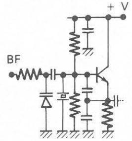
Fig.5. Modulation NBFM sur un oscillateur à quartz
