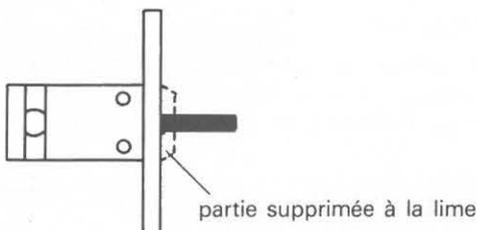
Revenons au circuit imprimé. Il faut, comme pour l'oscillateur local, ovaliser le trou prévu pour le logement des transistors MRF 901 afin d'obtenir des connections d'émetteur très courtes (fig.4).
