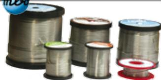
Soudure avec plomb, fluidité 5. Solidus 183°C, liquidus 190°C. Flux incorporé : activés résineux, type CA, CR2,2%
