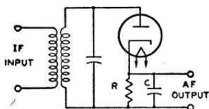
Fig. 22—Basic diode-detector circuit.
