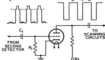
Fig. 80—Sync-separator circuit.
