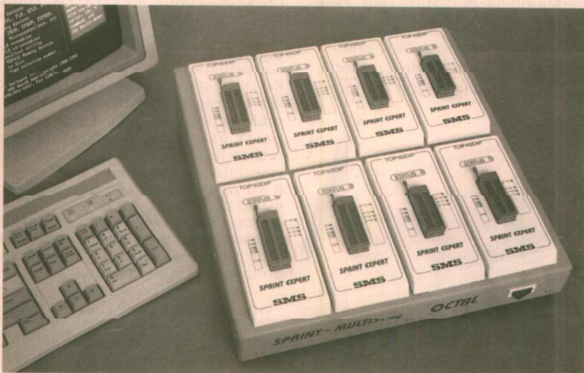
Ces programmeurs sont universels. Ils programment des EPROM, des microcontrôleurs, mais aussi des PAL de 4 à 32 circuits en parallèle selon le programmeur (QUAD ou OCTAL) et selon les «TOPS» utilisés.
