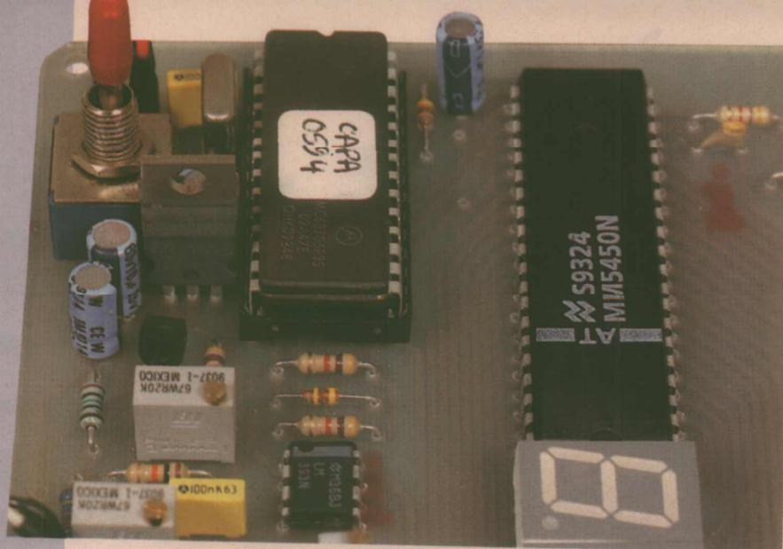
ge le condensateur C. La tension à ses bornes évolue linéairement. Un comparateur «enclenche» un chronomètre, et un autre «l'arrête». La valeur de la capacité peut alors s'écrire :
