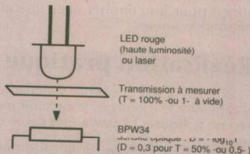
Figure 11 : disposition à prendre pour évaluer la transmission d'un matériau.
