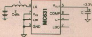
corporent une protection thermique qui se déclenche automatiquement lorsque la température de la puce dépasse un seuil limite déterminé afin d'éviter l'auto-destruction du circuit. De plus, ils ont été optimisés afin de réduire le courant de repos à 120µA sous 5 V.
