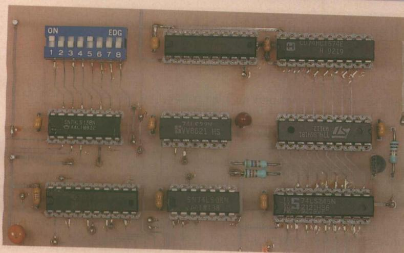
également, au niveau bas, le circuit CI2, un tampon huit bits bi-directionnel, utilisé pour isoler le bus de données du PC de la carte interface lorsque celle-ci n'est pas en fonction. La direction du transit des données est déterminée par le niveau appliqué sur la broche DIR. Lorsque ce dernier est bas, la carte peut transmettre des données vers le bus du microprocesseur. Lorsqu'il présente un niveau haut, le sens de transfert est inversé.
