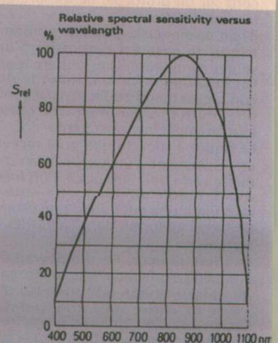
■ Figure 5 : réponse spectrale de la BPW 34.
