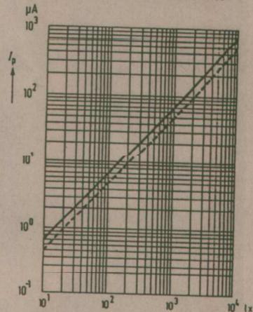
Figure 9 : courant fourni en fonction de l'éclairement.
