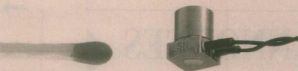
tement en dynamique ne doit pas être modifié par la masse supplémentaire du capteur.
