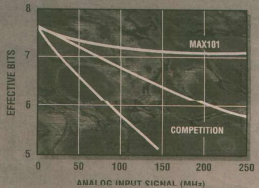
te d'entrée de 1,2 GHz et une incertitude d'ouverture inférieure à 2ps ; il en résulte une performance de 7,1 bits effectifs.
