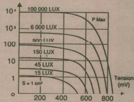
Figure 10 : caractéristique courant-tension pour un éclairement donné.
