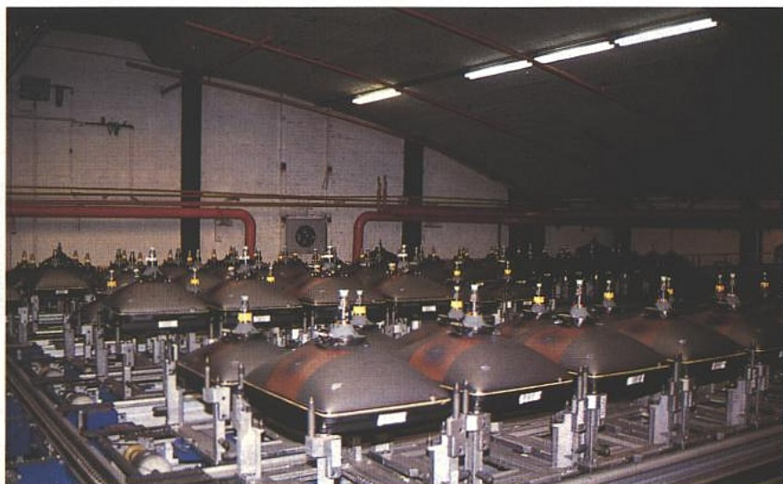
■ La tri des tubes achevés s'effectue automatiquement, grâce à leur code spécifique, avant emballage.
