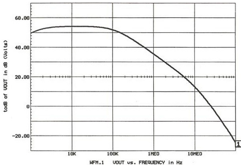
Figure 5 : réponse en petits signaux de l'ampli de la figure 3.
