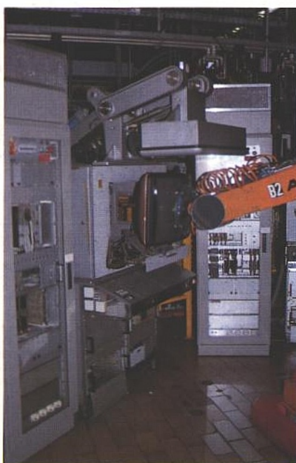
■ Préajustement de la convergence des trois faisceaux et de la pureté des couleurs. Le tube est directement positionné par le robot.
