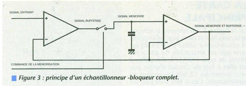
■ Figure 3 : principe d'un échantillonneur -bloqueur complet.
