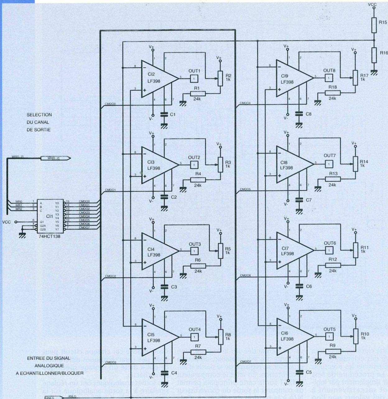
■ Figure 7 : schéma de l'extension sorties analogiques.
