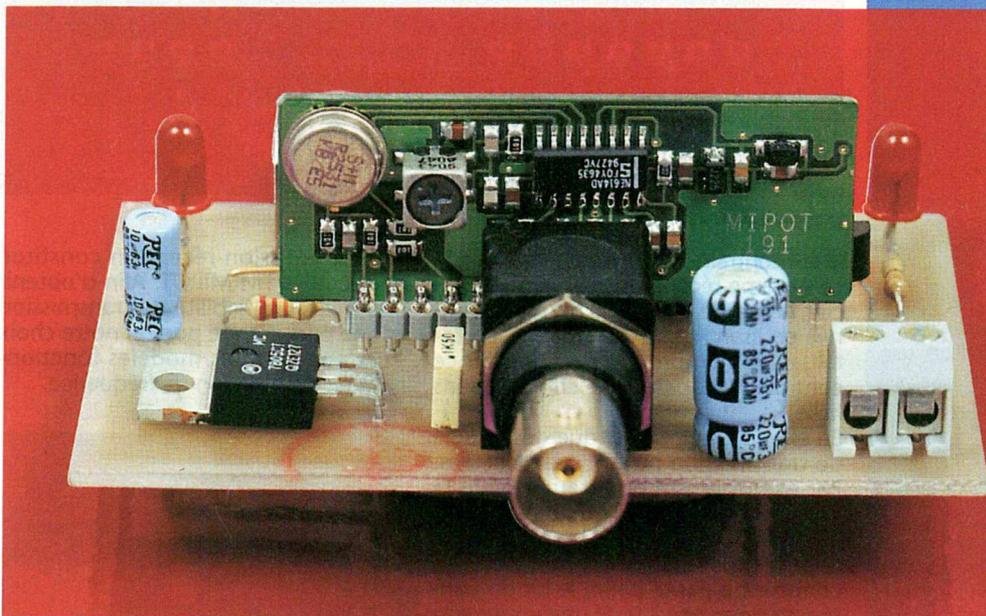
Nous avons dans un premier temps conçu un montage très simple. La liaison s'effectue par ondes radio et est unidirectionnelle. C'est à dire que l'un des micro-ordinateurs ne sera qu'émetteur et l'autre que récepteur, ce qui, nous en convenons, restreint nettement les applications possibles, applications qui pourront néanmoins être intéressantes :
