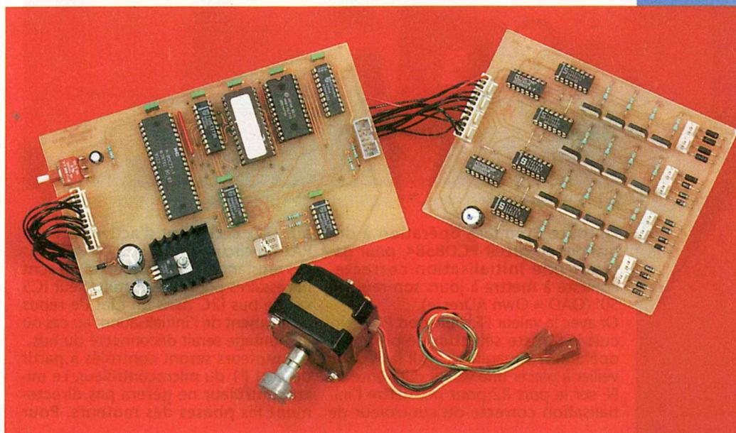
voire programme d'application, ce qui n'est pas très élégant et prend du temps machine. Il est bien plus agréable de confier la gestion des moteurs à une interface dédiée. C'est ce que nous vous proposons ce mois-ci, avec la réalisation d'une interface capable de piloter quatre moteurs pas à pas, totalement indépendants (de type unipolaire biphasé), via un bus I2C.
