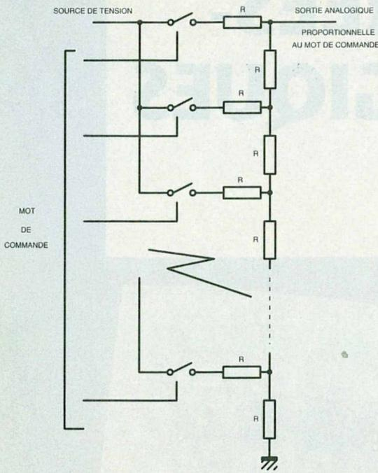
Figure 1 : principe du convertisseur N/A à réseau R/2R.
