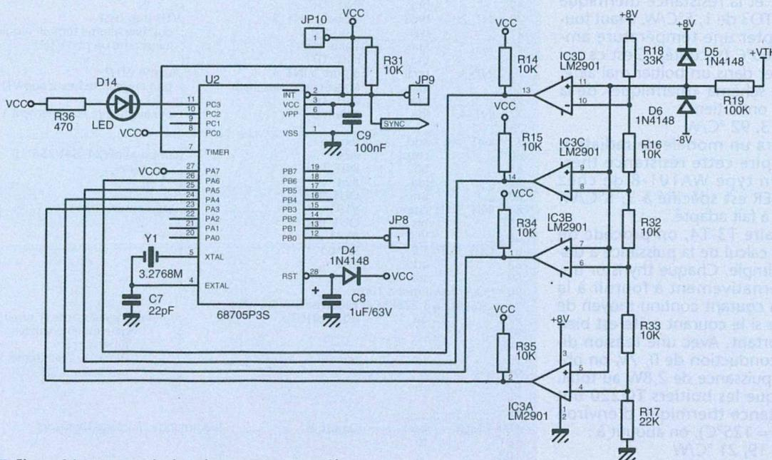
■ Figure 14 : commande de redressement «contrôlé».
