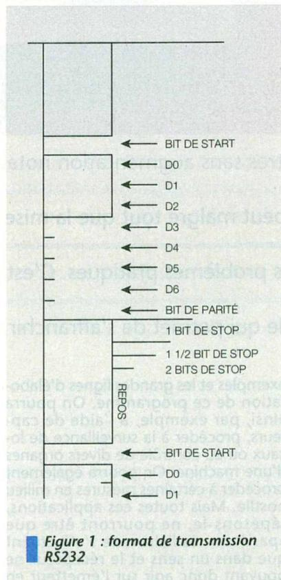
Figure 1 : format de transmission RS232
