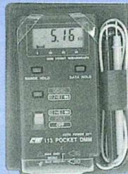
Affichage 3200 points • bargraph 32 segments • tensions continues calibre mini/maxi 320 mV / 450 V • résolution 100  $\mu$ V • précision de base 2% • tensions alternatives calibre mini/maxi 3,2 V/450 V • résolution 1 mV • précision de base 4% • résistance calibre mini/maxi 320  $\Omega$ /32 M $\Omega$  • résolution 0,1  $\Omega$  • précision 2% • test de diode/continuité • gammes automatiques.
