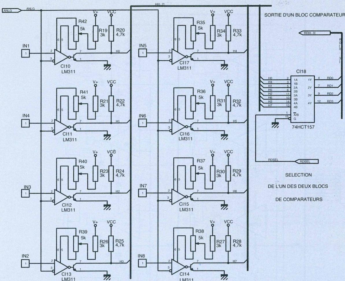
Figure 6 : schéma de l'extension entrées analogiques.
