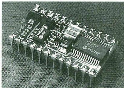
600 instructions) - une horloge 20 MHz (9600 bauds) - une interface PC série, plus de nouvelles instructions : commande d'aff., LCD, clavier, codage-décodage DTMF, bips sonores, comptage, codes «X10», etc.
