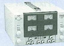
• Nombre de voies : 3 • Sorties variables tension 2 x 0 à 30 V • Courant max. 0 à 3A • Sorties fixes tension 5 V • Courant max 3A • résiduelle < 2 mV eff. • Stabilité 0,1% • Protection électronique contre court-circuit et surcharge • Dimensions (L x H x P) en mm 360 x 140 x 250.
