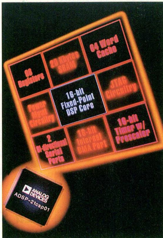
exécutant jusqu'à 550 millions d'opérations par seconde (Mops), un port DMA parallèle, un port mémoire parallèle, deux ports série multicanaux avec DMA et deux services d'interruptions à faible latence ayant un temps de commutation de tâche de 20 ns.
