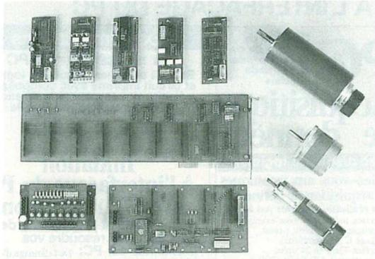
**IMPACK** se compose d'une carte support, (en slot, en liaison série, ou parallèle.) et de plus de 30 modules, qui s'enfichent sur les cartes supports.
