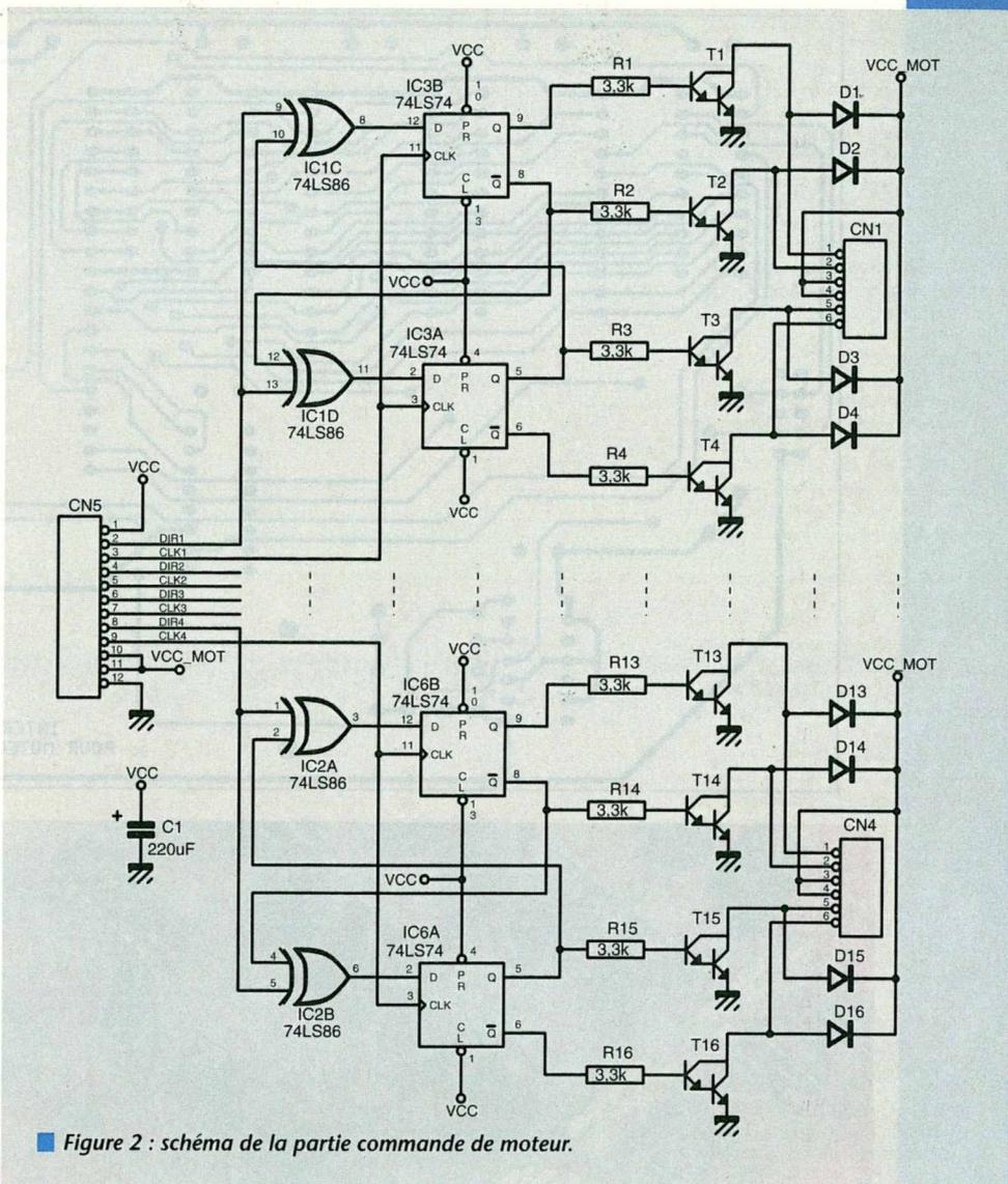
Figure 2 : schéma de la partie commande de moteur.
