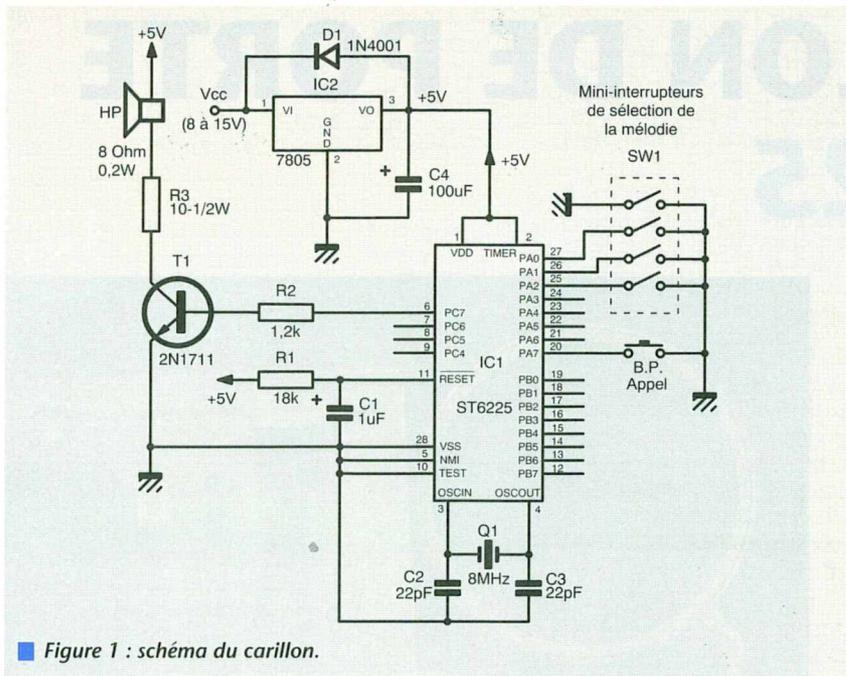
Figure 1 : schéma du carillon.
